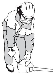
**REMARQUE!** Ne pas placer aucune partie du corps sur la surface marqué. Contact peut causer en brûlures à la peau ou les chocs électriques si le chapeau de bougie est defectueux. Toujours utiliser des gants. Ne jamais utiliser une machine dont le chapeau de bougie est defectueux.
