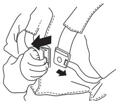
S'assurer du bon positionnement des bretelles du harnais. Quand le harnais et la machine sont ajustés, contrôler le bon fonctionnement du dispositif de libération rapide du harnais.
