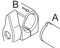
Pousser la fixation dans le raccord jusqu'à ce qu'un déclic indique qu'elle est bien en place.
