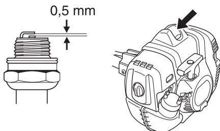
**REMARQUE!** Toujours utiliser le type de bougie recommandé! Une bougie incorrecte peut endommager le piston/le cylindre.
