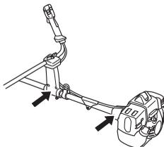
L'utilisation d'un fil mal enroulé ou d'un équipement de coupe mal affûté, défectueux (équipement non adapté ou mal affûté, voir le chapitre Affûtage de la lame) augmente le niveau des vibrations.
