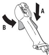
Vérifier d'abord que la commande de l'accélération est bloquée en position de ralenti quand le blocage de l'accélération est en position initiale.
