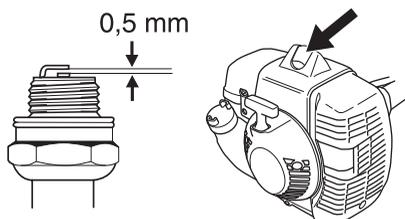
**REMARQUE!** Toujours utiliser le type de bougie recommandé! Une bougie incorrecte peut endommager le piston/le cylindre.
