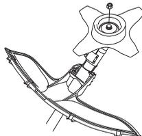
Pose: serrer l'écrou dans le sens contraire de la rotation de l'équipement de coupe. Dépose: desserrer l'écrou dans le sens de la rotation de l'équipement de coupe. (NOTA! L'écrou est fileté à gauche.) Serrer l'écrou à l'aide de la clé pour l'écrou de lame.
