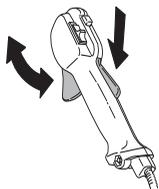
Voir le chapitre Démarrage. Démarrer la machine et donner les pleins gaz. Relâcher l'accélérateur et s'assurer que l'équipement de coupe s'arrête et qu'il reste immobile. Si l'équipement de coupe tourne lorsque l'accélérateur est au régime de ralenti, contrôler le réglage du ralenti du carburateur. Voir le chapitre Entretien.
