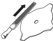
Maintenir un avoyage correct de la lame d'éclaircissage! Suivre nos instructions et utiliser le gabarit d'affûtage recommandé. Une lame d'éclaircissage mal affûtée augmente le risque de blocage et de rebond ainsi que d'endommagement de la lame.
