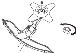
L'usure du verrouillage nylon du contre-écrou ne doit pas être telle qu'il peut se visser à l'aide des doigts. Le verrouillage doit résister à 1,5 Nm au moins. Remplacer le contre-écrou après une dizaine de serrages.
