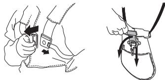
S'assurer du bon positionnement des bretelles du harnais. Quand le harnais et la machine sont ajustés, contrôler le bon fonctionnement du dispositif de libération rapide du harnais.
