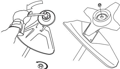
Die Nylonsicherung der Mutter darf nicht so abgenutzt sein, dass sie sich von Hand schrauben lässt. Die Sicherung soll mindestens 1,5 Nm halten. Nachdem sie ca. 10 Mal aufgeschraubt worden ist, ist die Mutter auszutauschen.
