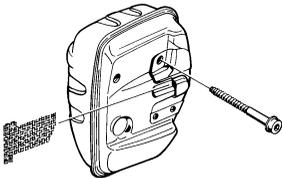
Bei Schalldämpfern ohne Katalysator sollte das Netz einmal in der Woche gereinigt und ggf. ausgetauscht werden. Bei Katalysatorschalldämpfern ist das Netz einmal im Monat zu kontrollieren und evtl. zu reinigen.
