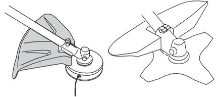
Den Schutz auf Schäden und Risse kontrollieren. Den Schutz austauschen, wenn er Schlägen ausgesetzt war oder Risse aufweist.
