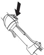
Den Motor starten und kontrollieren, ob der Motor stoppt, wenn der Stoppsschalter in Stoppstellung geführt wird.
