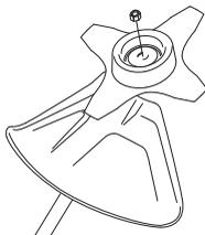
Pri montaži priključkov zategnite matico v nasprotni smeri rotacije rezilnih priključkov. Pri demontaži rezilnih priključkov
