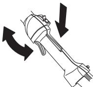
Glej poglavje pod naslovom Vžig. Vžgite stroj in mu dajte polni plin. Izpustite plinsko ročico in se prepričajte, da se rezilni priključek ustavi in obmiruje. Če se rezilni priključek vrti, ko je plinska ročica v legi prostega teka, preglejte nastavitve uplinjača v prosti legi. Glejte navodila v poglavju Vzdrževanje.
