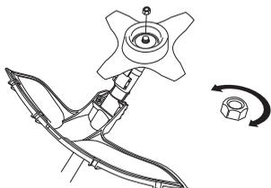
Matični nylonski zatič ne sme biti tako izrabljen, da ga je mogoče odvit s prsti. Navoj mora zdržati najmanj 1,5 Nm. Matico po desetkratni uporabi zamenjajte.
