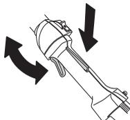
Glej poglavje pod naslovom Vžig. Vžgite stroj in mu dajte polni plin. Izpustite plinsko ročico in se prepričajte, da se rezilni priključek ustavi in obmiruje. Če se rezilni priključek vrti, ko je
