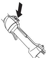
Vžgite motor in preverite, če se ustavi, ko izklopno stikalo potisnete v položaj STOP.
