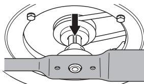
Monter fjederskiven, og spænd bolten og skiven korrekt. Bolten skal spændes med et tilspændingsmoment på 45-60 Nm.
