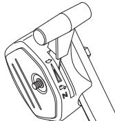
Motoren standses ved at slippe motorbremsebøjlen.
