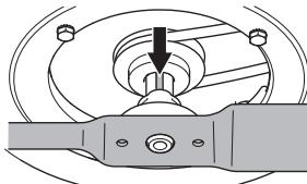
Monter sprengskiven og trekk til bolten og skiven på riktig måte. Bolten må trekkes til med et moment på 45-60 Nm.
