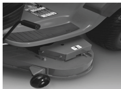
A continuación, carcasa de plataforma moldeada, NO reforzada
