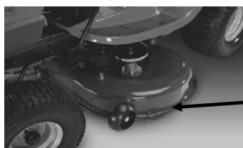
A continuación, carcasa de plataforma moldeada, NO reforzada
