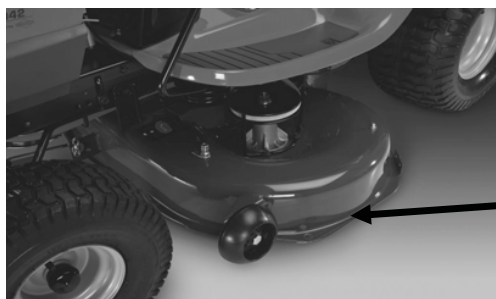
Coque d'unité de coupe estampée ci-dessous, NON renforcée
