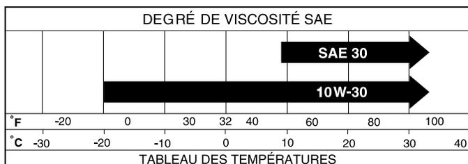
**REMARQUE:** Les huiles de multiviscosité (5W30, 10W30 etc.) améliorent le démarrage pendant le temps froid, et vérifiez le niveau d'huile de moteur fréquemment pour éviter l'endommagement du moteur dû à l'utilisation avec un niveau d'huile bas.
