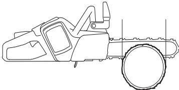
Es gibt Methoden zum Fällen von Bäumen, deren Stammdurchmesser größer ist als die Führungsschienenlänge. Bei solchen Methoden besteht große Gefahr, dass der Rückschlagbereich der Führungsschiene mit einem Gegenstand in Berührung kommt.
