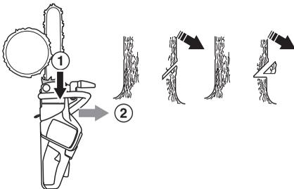
Die Schnitttiefe der Kerbe soll etwa 1/4 des Stammdurchmessers und der Winkel zwischen dem oberen und unteren Schnitt mindestens 45° betragen.
