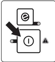
Opomba! Da preprečite nehoten vklop, akumulator vedno odstranite, ko naprave ne uporabljate ali kadar ni pod nadzorom. Če želite odstraniti akumulator, ga povlecite iz naprave in hkrati držite gumba za sprostitev akumulatorja.
