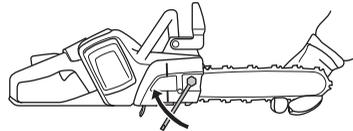
An einer neuen Kette muss die Kettenspannung oft kontrolliert werden, bis die Kette eingefahren ist. Die Kettenspannung regelmäßig prüfen. Mit einer richtig gespannten Kette wird eine gute Schnittleistung und eine lange Lebensdauer erzielt.
