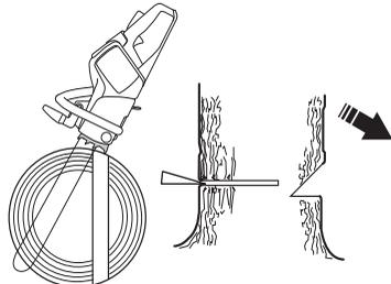
Der Fällschnitt soll parallel zur Kerbschnittlinie abschließen, so dass der Abstand zwischen beiden Schnitten mindestens 1/10 des Stammdurchmessers beträgt. Der nicht durchgesägte Teil des Stamm wird als Brechmaß bezeichnet.
