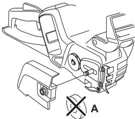
Die Schiene über den Schienenbolzen montieren. Die Schiene in der hintersten Position aufsetzen. Die Kette um das Kettenantriebsrad und in die Schienennut legen. Auf der Oberseite der Schiene beginnen.
