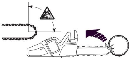
Žaganje s spodnjim robom meča, to se pravi od zgoraj navzdol, se imenuje žaganje na vlek. V tem primeru žago vleče proti deblu, njeno težo pa nosi spodnji rob meča. Ta način žaganja omogoča uporabniku boljši nadzor žage in položaja odbojnega območja meča.
