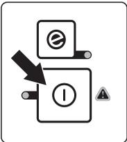
Hinweis! Um das unbeabsichtigte Starten zu vermeiden, muss die Batterie stets entfernt werden, wenn die Maschine nicht verwendet oder überwacht wird. Zum Entfernen der Batterie muss diese bei gedrückter Freigabetaste an der Batterie herausgezogen werden.
