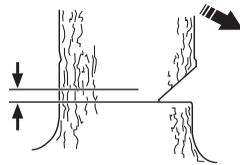
Die Rindenstütze (falls montiert) hinter dem Brechmaß ansetzen. Mit Vollgas sägen und mit der Sägekette/Führungsschiene langsam in den Baumstamm schneiden. Aufpassen, ob sich der Baumstamm entgegengesetzt zur Fällrichtung bewegt. Einen Fällkeil oder einen Fällheber in den Fällschnitt schieben, sobald die Schnitttiefe dies gestattet.
