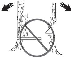
Wenn Kerb- und Fällschnitt ausgeführt sind, soll der Baum von selbst oder mit Hilfe von Fällkeil oder Fällheber fallen.
