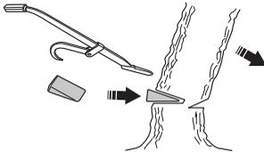
Wir empfehlen eine Führungsschienenlänge zu benutzen, die größer ist als der Stammdurchmesser, sodass Kerb- und Fällschnitt mit einem sog. einfachen Sägeschnitt ausgeführt werden können. Siehe die Anweisungen unter der Überschrift Technische Daten hinsichtlich der Schienenlängen, die für Ihr Motorsägenmodell empfohlen werden.
