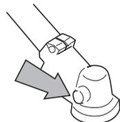
En général, il n'est pas nécessaire de remplacer le lubrifiant du carter, sauf en cas de réparations.
