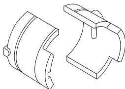
Vérifier régulièrement l'état des éléments afin de détecter fissures et déformations. Vérifier que les éléments anti-vibrations sont entiers et solidement fixés.
