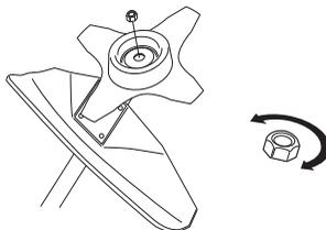
Les dents de la lame d'éclaircissage risquent de causer des blessures aussi bien lors du serrage que du desserrage de l'écrou de la lame. Veiller à ce que la main soit toujours protégée par le protège-lame lors de ces interventions. Toujours utiliser une clé à douille munie d'un manche assez long. La flèche sur l'illustration indique la zone dans laquelle la clé doit être utilisée, aussi bien pour serrer que pour desserrer l'écrou.
