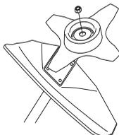
Pose: serrer l'écrou dans le sens contraire de la rotation de l'équipement de coupe. Dépose: desserrer l'écrou dans le sens de la rotation de l'équipement de coupe.
