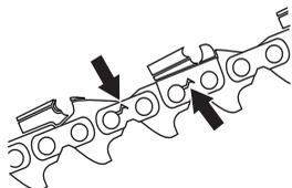
Il est recommandé de comparer avec une chaîne neuve pour évaluer le degré d'usure.
