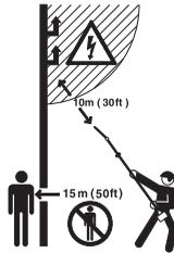
La machine a une longue portée. Vérifier qu'aucune personne et qu'aucun animal ne se trouvent à moins de 15 mètres quand la machine est utilisée.
