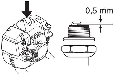
**REMARQUE!** Toujours utiliser le type de bougie recommandé! Une bougie incorrecte peut endommager le piston/le cylindre. S'assurer que la bougie est dotée d'un antiparasites.
