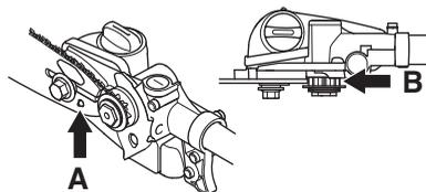
Tendre la chaîne en vissant la vis du tendeur de chaîne dans le sens des aiguilles d'une montre. Utiliser une clé universelle ou visser à la main. Tendre la chaîne jusqu'à ce qu'elle ne pende plus sous le guide.
