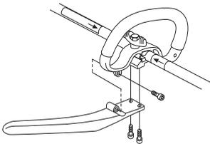
Nato opravite fino nastavitvev in se tako namestite v udoben delovni položaj. Zategnite vijake.
