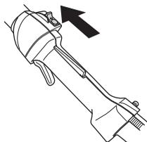
Vžigite motor in preverite, če se ustavi, ko izklopno stikalo potisnete v položaj STOP.
