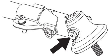
Das Schmiermittel im Getriebegehäuse braucht normalerweise nur bei evtl. Reparaturen gewechselt zu werden.
