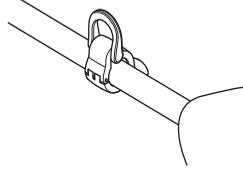
Befestigen Sie bei Verwendung von Grasklingen den Schultergurt an der Aufhängöse.
