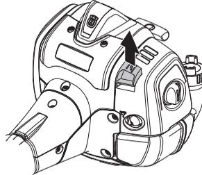
Das Luftfiltergehäuse demontieren und den Filter herausnehmen. Den Filter in warmer Seifenlauge waschen. Mithilfe von Druckluft oder einer Bürste auch das Innere des Filterdeckels reinigen. Dafür sorgen, dass der Filter trocken ist, wenn er wieder montiert wird.
