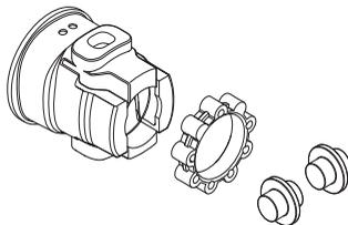
Redno preverjajte stanje elementov za dušenje vibracij. Bodite pozorni na morebitne razpoke in druge deformacije. Prepričajte se, če so dušilni elementi celi in dobro pritrjeni.
