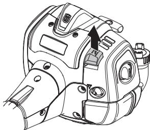
Razstavite ohišje filtra in odstranite filter. Operite ga v topli milnici. Z zrakom ali krtačo očistite tudi notranjost pokrova filtra. Prepričajte se, da je filter suh, predno ga ponovno montirate.
