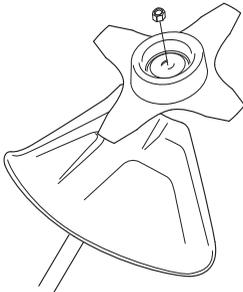
Bei der Montage die Mutter entgegen der Rotationsrichtung der Schneidausrüstung anziehen. Bei der Demontage die Mutter in der Rotationsrichtung der Schneidausrüstung lösen. (ACHTUNG! Die Mutter hat ein Linksgewinde.)
