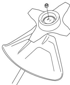
Pri montaži priključkov zategnite matico v nasprotni smeri rotacije rezilnih priključkov. Pri demontaži rezilnih priključkov zrahljajte matico v smeri vrtenja. (POZOR! Matica ima levi navoj.)
