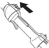
Den Motor starten und kontrollieren, ob der Motor stoppt, wenn der Stoppschalter in Stoppstellung geführt wird.
