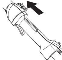
**ACHTUNG!** Der Stoppschalter geht automatisch in die Startstellung zurück. Um ein ungewolltes Starten zu vermeiden, muss bei Montage, Kontrolle und/oder Wartung daher stets die Zündkappe von der Zündkerze entfernt werden.
