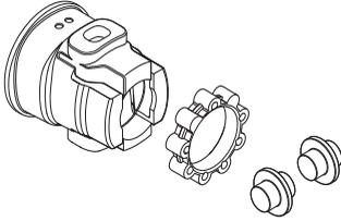
Die Antivibrationselemente regelmäßig auf Risse und Verformungen überprüfen. Kontrollieren, ob die Vibrationsdämpfer unbeschädigt und fest verankert sind.
