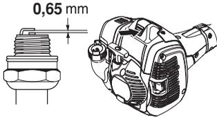
**ACHTUNG!** Stets den vom Hersteller empfohlenen Zündkerzentyp verwenden! Eine ungeeignete Zündkerze kann Kolben und Zylinder zerstören. Dafür sorgen, dass die Zündkerze eine sog. Funkenstörung hat.
