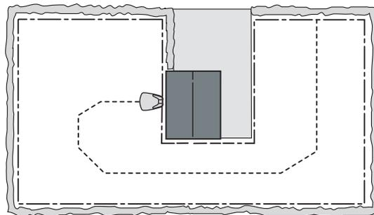
Lorsque la batterie est complètement chargée, le robot de tonte quitte la station de charge et commence à tondre dans une direction aléatoire comprise dans un secteur allant de  $90^\circ$  à  $270^\circ$ .
