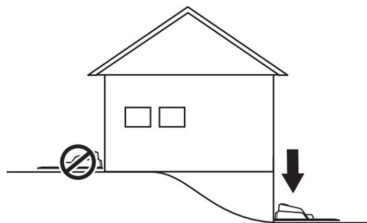
La station de charge ne doit pas être placée sur un îlot, car ceci limiterait les possibilités de mise en place du câble guide. Si elle doit impérativement être installée sur un îlot, le câble guide devra également être connecté à l'îlot. Voir l'illustration. Lisez le chapitre 3.4 *Installation du câble périphérique* pour en savoir plus sur les îlots.
