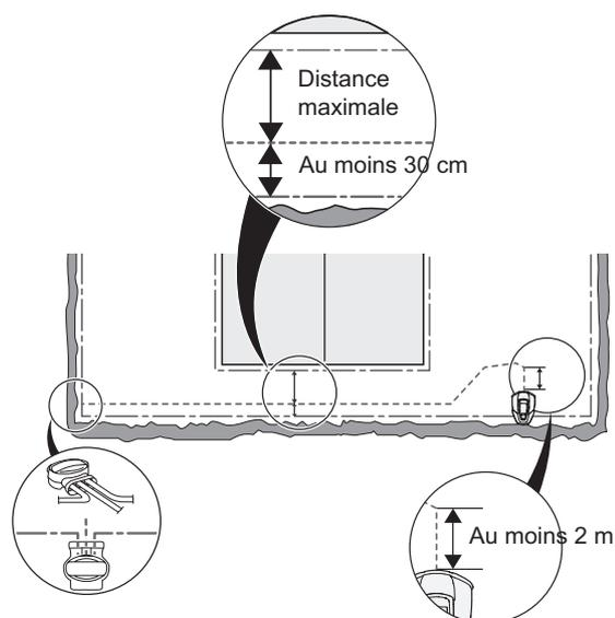
Si le câble guide doit être installé sur une pente raide, il est recommandé de placer le câble en formant un angle avec la pente. Le robot de tonte pourra ainsi suivre plus facilement le câble guide sur la pente.
