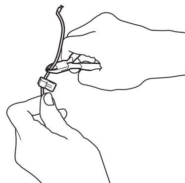
4. Poussez le connecteur sur les broches de contact, portant les marques AL (gauche) et AR (droite), sur la station de charge.
