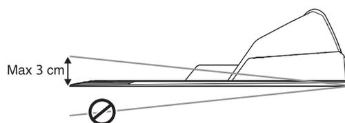
Le positionnement de la station de charge ne doit pas plier sa plaque de base.
