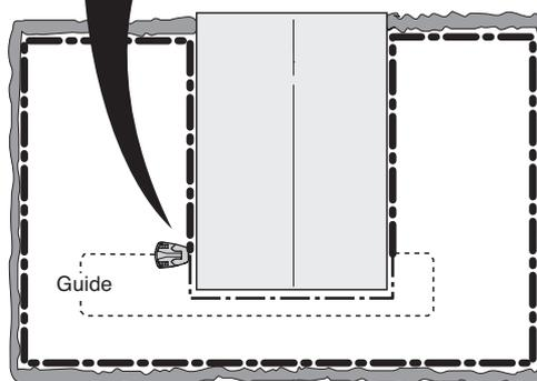
b) Replacez les connexions A1 et Guide sur leurs positions d'origine. Puis intervertissez les connexions A2 et Guide.
