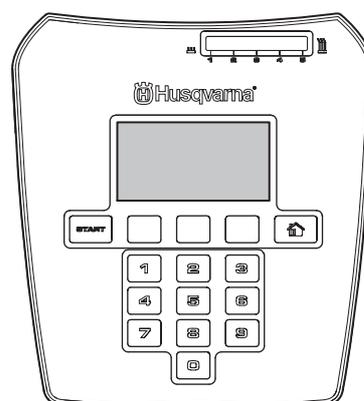
Si le bouton **STOP** est actionné et que le capot est ouvert, la fenêtre de fonctionnement affiche l'heure, le mode de fonctionnement sélectionné, le nombre d'heures de tonte, l'état de la batterie et le réglage de la minuterie.
