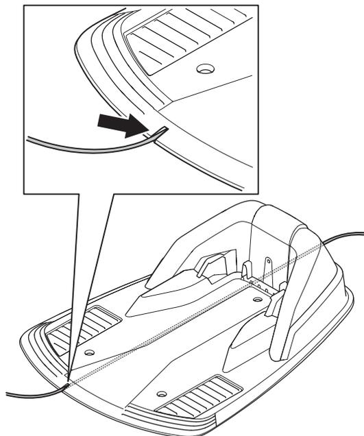
2. Branchez le connecteur au câble guide de la même façon que le câble périphérique, tel que décrit au 3.5 *Connexion du câble périphérique*. Branchez-le sur la broche de contact de la station de charge indiquant Guide.
