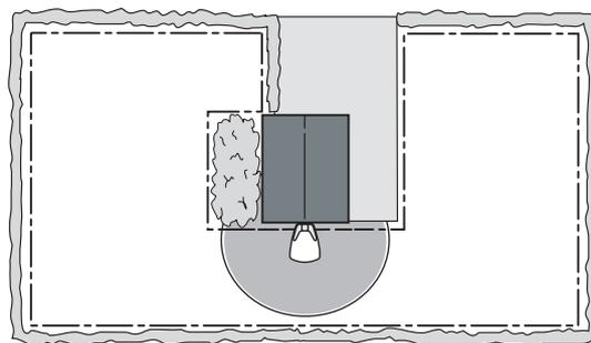
Ne placez pas la station de charge dans un espace confiné de la zone de travail. Le câble périphérique doit sortir en ligne droite sur au moins 5 ft (1,5 m) de long, à droite et à gauche de la station de charge. Le câble doit être positionné en ligne droite depuis l'arrière de la station de charge. Tout autre positionnement obligerait le robot de tonte à pénétrer dans la station de charge par le côté en rendant difficile son arrimage.
