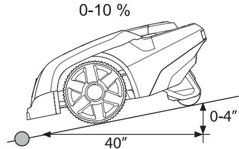
Le câble périphérique ne doit pas traverser une pente dont l'inclinaison est supérieure à 10 %. Le robot de tonte risque de tourner difficilement. Le robot de tonte peut alors s'arrêter et le message d'erreur *En dehors de la zone de tonte* s'affiche. Le risque est maximal en cas de temps humide car les roues sont susceptibles de glisser sur l'herbe mouillée.
