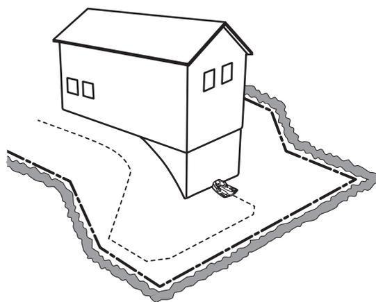
Évitez de poser le câble dans des angles aigus. Il peut ainsi être difficile pour le robot de tonte de suivre le câble guide.
