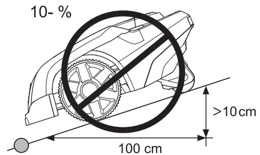
Cependant, s'il y a un obstacle que le robot de tonte a le droit de heurter, par exemple une barrière ou une haie dense, le câble périphérique peut être posé sur une pente de plus de 10 %.
