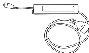
Le câble basse tension relié au transformateur mesure 33 ft (10 m) et ne peut être ni raccourci, ni rallongé.
