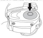
Contrôler le conduit d'air situé sous le capot du moteur. Il doit être propre et ne pas frotter contre la prise d'air de refroidissement.
