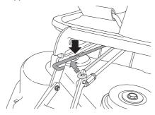
4 Desserrez le ressort du tendeur de la courroie d'entraînement en tirant sur l'œil de ressort.
