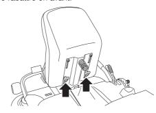
Le siège peut également être ajusté longitudinalement. Desserrer les manettes sous le siège et le régler vers l'avant ou l'arrière sur la position souhaitée.
