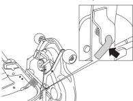
2 Remettre en place l'étai de hauteur de coupe et la courroie. Tendre la courroie à l'aide du tendeur de courroie.
