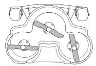
IMPORTANT! Une ou plusieurs lames déséquilibrées, suite à une détérioration ou un équilibrage mal effectué après l'affûtage, peuvent provoquer des vibrations dans la machine.
