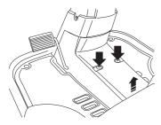
2 Contrôler la tension des câbles de commande en les serrant l'un contre l'autre au niveau des flèches comme montré sur l'illustration. La distance entre les deux câbles doit pouvoir diminuer de moitié sans trop forcer en pinçant.
