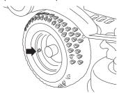
REMARQUE! Si les pneus avant n'ont pas la même pression, les couteaux couperont l'herbe à des hauteurs inégales. Il est important que la pression d'air soit la même dans tous les pneus afin d'obtenir des performances optimales et d'éviter d'endommager la machine.
