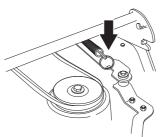
6 Lever la courroie d'entraînement et l'accrocher sur le crochet de support.
