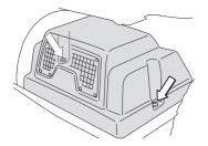
2 Rider 213 C, Rider 216 Contrôler que le réservoir d'huile de la transmission est bien rempli d'huile. Remplir, si nécessaire, avec de l'huile moteur SAE 10W/40 (classe SF–CC).
