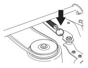
5 Lever la courroie d'entraînement et l'accrocher sur le crochet de support.
