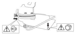
2 Graisser à l'aide d'une seringue le graisseur depuis la droite sous la poulie inférieure du moteur jusqu'à ce que la graisse pénètre.
