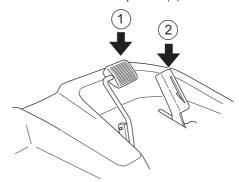
La machine freine lorsque la pédale de marche avant est relâchée. La pédale de marche arrière peut également être utilisée si une puissance de freinage supplémentaire est nécessaire.
