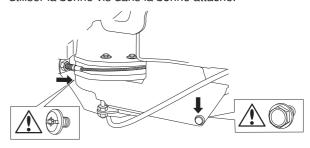
Si la machine est utilisée tous les jours, le graissage doit être effectué deux fois par semaine.
