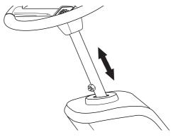
5 Serrez la vis de blocage et l'écrou. Remettez le capot en place.
