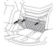
Desserrez les vis et retirez les plaques de protection.
