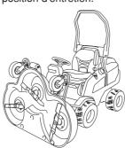
12 Fixez fermement l'unité de coupe à l'aide de la ceinture de sécurité rangée dans le compartiment de stockage situé sous le siège.
