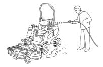
Les dépôts d'huile peuvent être éliminés avec un produit de dégraissage froid. En passer une fine couche.
