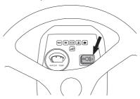
La prise électrique permet par exemple de brancher un coussin chauffant ou un chargeur de téléphone portable.
