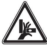
Pavojus sutraškyti, patekus tarp kėlimo svirčių ir pagrindo plokštės.
