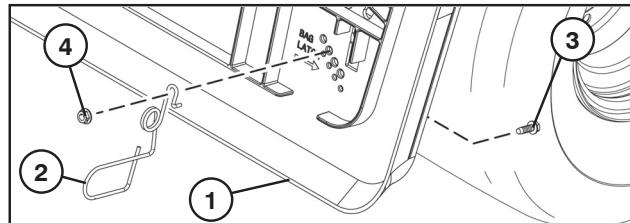
**HINWEIS:** Die Unterseite der Fangkorbeinheit muss das Schlaufenende so berühren, dass sie im geschlossenen Zustand gut gesichert ist.
