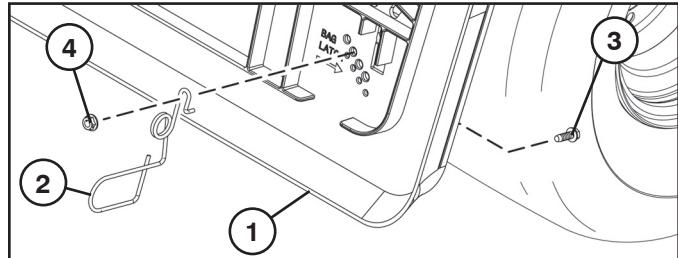
**NOTA:** La parte inferior de la ensacadora debe hacer contacto con el extremo de bucle para que quede firmemente fijada cuando esté cerrada.
