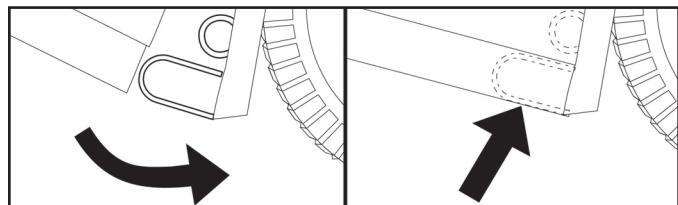
**NOTA:** Se è stata modificata l'altezza del gruppo del sacco di raccolta, può essere necessario regolare anche il dispositivo di aggancio. Per fare ciò, togliere il dado (4) e spostare il dispositivo di aggancio del sacco nel foro desiderato nella piastra posteriore (1), verificando che sia chiuso in maniera corretta. Serrare nuovamente il dado in maniera sicura.
