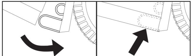
**REMARQUE:** Après un réglage en hauteur de l'ensemble du bac de ramassage, il peut être nécessaire d'ajuster le verrou à ressort du bac. Pour effectuer cet ajustement, enlevez l'écrou (4) et déplacez le verrou à ressort du bac de ramassage jusqu'au trou approprié de la plaque de support (1), de manière à assurer que l'ensemble du bac soit bien fermé. Resserrez correctement l'écrou.
