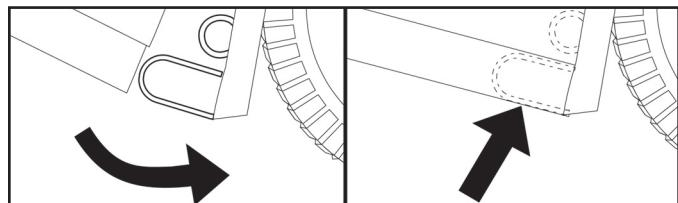
**NOTA:** Si se ajusta la altura del conjunto de ensacadora, puede ser necesario ajustar el seguro de muelle de la misma. Para ajustarlo, retire la tuerca (4) y mueva el seguro de muelle de la ensacadora al orificio adecuado en la placa de apoyo (1), asegurándose de que el conjunto de ensacadora esté bien cerrado. Vuelva a apretar la tuerca.
