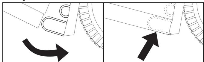
**OPMERKING:** Als de hoogte van de opvangzakconstructies is ingesteld, kan het nodig zijn om de veervergrendeling van de opvangzak aan te passen. Om dit te doen verwijdert u de moer (4) en verplaatst u de veergrendeling van de opvangzak naar het juiste gat in de achterplaat (1); zorg ervoor dat de opvangzakconstructie goed gesloten wordt. Draai de moer weer stevig vast.
