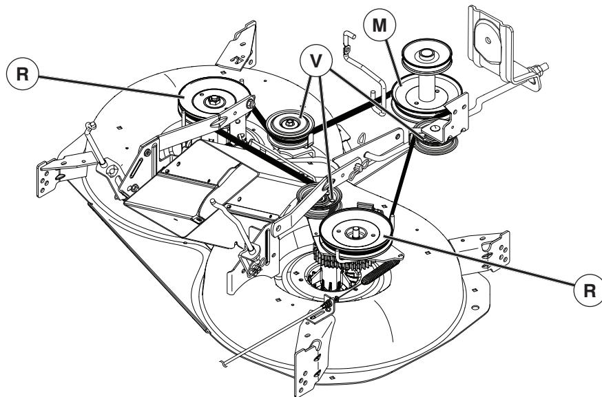
**IT Sostituzione della cinghia di trasmissione del rasaerba**
