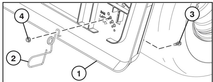
**OPMERKING:** De onderkant van de opvangbak moet in contact staan met het lusuiteinde zodat deze goed vastzit als deze wordt gesloten.
