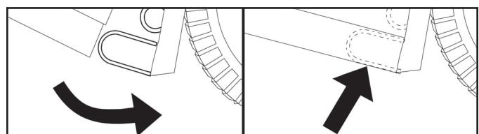
**HINWEIS:** Wenn die Fangkorbhöhe eingestellt wird, kann es erforderlich werden, die Federverriegelung des Fangkorbs einzustellen. Für diese Einstellung die Mutter (4) löschen und die Federverriegelung des Fangkorbs in die entsprechende Bohrung in der Trägerplatte (1) so einsetzen, dass der Fang fest geschlossen ist. Die Mutter wieder fest anziehen.
