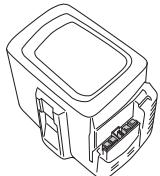
Håll batteriets styrspår rena. Rengör plastdetaljer med en ren och torr trasa.
