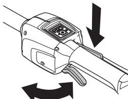
Se anvisningar under rubrik Start och Stopp. Starta maskinen och ge full gas. Släpp gasreglaget och kontrollera att skärutrustningen stannar och att den förblir stillastående.
