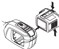
**VIGTIG!** Fjern alltid batteriet for å hindre at maskinen startes ved et uhell.
