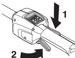
Kontrollera att gasreglaget är låst när gasreglagespärren är i sitt ursprungsläge.
