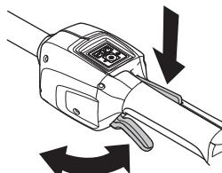
Se anvisningerne under overskriften Start. Start maskinen, og giv fuld gas. Slip strømudløseren, og kontrollér, at skæreudstyret standser, og at det forbliver i stilstand.
