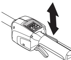
Kontroller at effektregulatoren og effektregulatorsperren går lett og at returfjæren fungerer som den skal.
