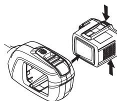
**VIGTIGT!** Batteriet skal altid udtages for at forhindre, at maskinen starter utilsigtet.
