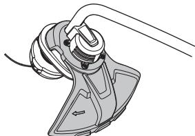
Kontrollera att skyddet är oskadat och fritt från sprickbildung. Byt skydd om det utsatts för slag eller har sprickor.
