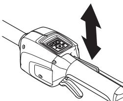
Tarkasta, että käyttöliipaisin ja sen varmiston liikkuvat vapaasti ja että niiden palautusjärjestelmät toimivat.
