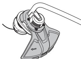
Kontrollér, at beskyttelsen er intakt og fri for revner. Udskift beskyttelsen, hvis den har været utsat for slag eller har revner.
