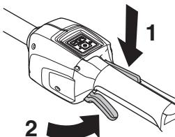
Tarkasta, että käyttöliipaisin on lukittu, kun käyttöliipaisimen varmiston on alkuasennossa.
