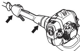
Het trillingdempingssysteem van de machine reduceert het overbrengen van de trillingen van de motoreenheid/snijuitrusting op de handvatseenheid van de machine.
