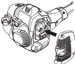
Bepaalde geluiddempers zijn voorzien van een speciaal vonkenopvangnet. Indien uw machine uitgerust is met zo'n geluiddemper, moet u het net minstens één keer per week schoonmaken. Gebruik bij voorkeur een stalen borstel.
