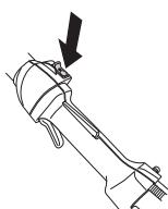
Start de motor en controleer of de motor wordt uitgeschakeld wanneer de stopschakelaar in de stopstand wordt gezet.
