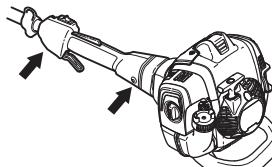
Le système anti-vibrations réduit la transmission des vibrations de l'unité moteur/l'équipement de coupe à l'unité que constituent les poignées.
