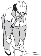
**N.B.!** Plaats geen enkel lichaamsdeel op het gemarkeerde vlak. Contact kan leiden tot brandwonden aan de huid of een elektrische schok wanneer het ontstekingsmechanisme kapot is. Gebruik altijd handschoenen. Gebruik nooit een machine met een kapot ontstekingsmechanisme.
