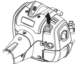
Luftfilterabdeckung abnehmen und Filter entfernen. Mit Druckluft reinigen.
