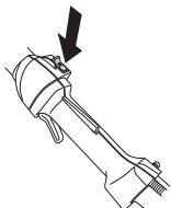
Den Motor starten und kontrollieren, ob der Motor stoppt, wenn der Stoppschalter in Stoppstellung geführt wird.
