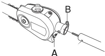
**REMARQUE!** S'assurer que l'arbre d'entraînement du tube de transmission pénètre dans la rainure de la tête de coupe.
