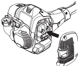
Bestimmte Schalldämpfer sind mit einem speziellen Funkenfangnetz ausgerüstet. Ist Ihr Gerät mit einem derartigen Schalldämpfer ausgestattet, so ist das Netz einmal wöchentlich zu säubern. Dies geschieht am besten mit einer Stahlbürste.
