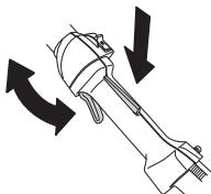
Zie instructies in het hoofdstuk Start. Start de machine en geef vol gas. Laat de gashendel los en controleer of de snijuitrusting stopt en stil blijft staan. Als de snijuitrusting roteert wanneer de gashendel in de stationaire stand staat, moet de stationairstand van de carburetor gecontroleerd worden. Zie instructies in het hoofdstuk Onderhoud.
