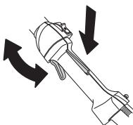
Siehe die Anweisungen unter der Überschrift Start. Gerät starten und Vollgas geben. Den Gashebel loslassen und kontrollieren, ob die Schneidausrüstung völlig zum Stillstand kommt. Wenn die Schneidausrüstung rotiert, während sich der Gashebel in Leerlaufstellung befindet, ist die Leerlaufinstellung des Vergasers zu kontrollieren. Siehe die Anweisungen unter der Überschrift Wartung.
