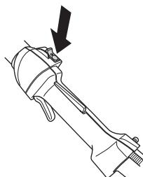
**ACHTUNG!** Der Stoppschalter geht automatisch in die Startstellung zurück. Um ein ungewolltes Starten zu vermeiden, muss bei Montage, Kontrolle und/oder Wartung daher stets die Zündkappe von der Zündkerze entfernt werden.
