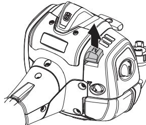
Verwijder het luchtfILTERdeksel en het filter. Blaas schoon met perslucht.
