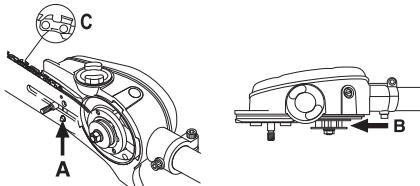
Span de ketting door de kettingspanschroef met de klok mee te draaien. Gebruik een combiseutel of draai met de
