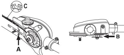
Tendre la chaîne en vissant la vis du tendeur de chaîne dans le sens des aiguilles d'une montre. Utiliser une clé
