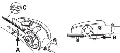
Die Kette durch Schrauben der Kettenspannerschraube im Uhrzeigersinn spannen. Den Kombischlüssel benutzen oder von Hand schrauben. Die Kette ist zu
