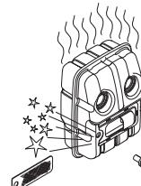
Sur les silencieux sans pot catalytique, la grille doit être nettoyée et si nécessaire remplacée une fois par semaine. Sur les machines dont le silencieux est muni d'un pot catalytique, la grille devra être inspectée et si nécessaire nettoyée une fois par mois. **Si la grille est abîmée, elle devra être remplacée.**
