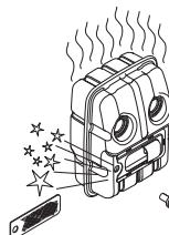
Bei Schalldämpfern ohne Katalysator sollte das Netz einmal in der Woche gereinigt und ggf. ausgetauscht werden. Bei Katalysatorschalldämpfern ist das Netz einmal im Monat zu kontrollieren und evtl. zu reinigen.
