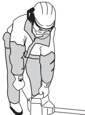
**ACHTUNG!** Kein Körperteil darf auf die markierte Fläche geraten. Der Kontakt kann zu Hautverbrennungen oder elektrischen Schlägen führen, wenn die Zündkappe defekt ist. Stets Handschuhe tragen. Niemals eine Maschine mit defekter Zündkappe verwenden.
