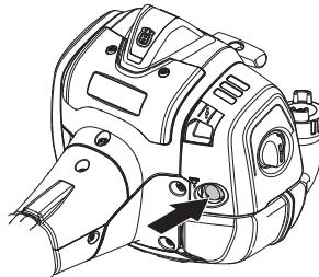
**Choke:** Den Chokehebel in Choke-Lage führen.
