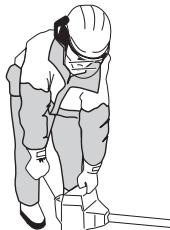
**REMARQUE!** Ne pas placer aucune partie du corps sur la surface marqué. Contact peut causer des brûlures à la peau ou des chocs électriques si le chapeau de bougie est défectueux. Toujours utiliser des gants. Ne jamais utiliser une machine dont le chapeau de bougie est défectueux.
