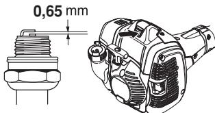
**ACHTUNG!** Stets den vom Hersteller empfohlenen Zündkerzentyp verwenden! Eine ungeeignete Zündkerze kann Kolben und Zylinder zerstören. Dafür sorgen, dass die Zündkerze eine sog. Funkentstörung hat.
