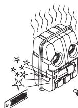
Op geluiddempers zonder katalysator moet het net één keer per week worden schoongemaakt en eventueel worden vervangen. Op geluiddempers met katalysator moet het net één keer per maand worden gecontroleerd en eventueel schoongemaakt. **Bij evt. beschadigingen aan het net moet dit vervangen worden.**
