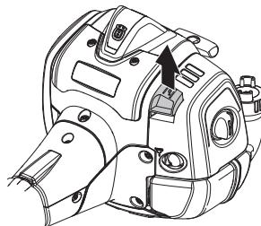
Déposer le capot de filtre et retirer le filtre. Nettoyer à l'air comprimé.
