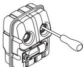
Ist der Schalldämpfer Ihres Gerätes mit einem Funkenfangnetz versehen, muss dieses regelmäßig gereinigt werden. Ein verstopftes Netz verursacht ein Heißlaufen des Motors mit schweren Motorschäden als Folge.
