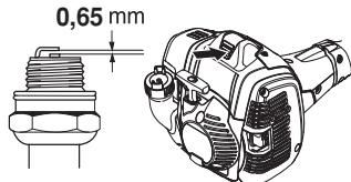
**REMARQUE!** Toujours utiliser le type de bougie recommandé! Une bougie incorrecte peut endommager le piston/le cylindre. S'assurer que la bougie est dotée d'un antiparasites.
