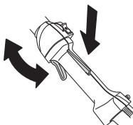
Skatiet norādījumus zem rubrikas Iedarbināšana. Iedarbiniet mašīnu un padodiet pilnu gāzi. Atlaidiet drosele un pārbaudiet, vai griešanas aprīkojums apstājās un paliek nekustīgs. Ja griešanas aprīkojums griežas, kad drosele ir tukšgaitas pozīcijā, tad jāpārbauda karburatora tukšgaitas noregulējums. Skatiet norādījumus zem rubrikas Apkope.
