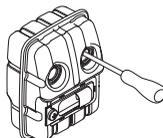
Kui seadmel on summuti, mis on varustatud sädemepüüdjaga, peab ka seda ühtlaste ajavahemike järel puhastama. Saastunud võrguga sädemepüüdja tõttu võib mootor üle kuumeneda ja katki minna.
