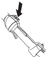
Iedarbiniet motoru un pārliecinieties, ka motors apstājas, kad stop slēdzi pārbīda uz stop pozīciju.
