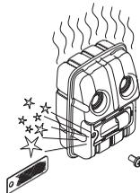
Trokšņu slāpētājiem bez katalizatora dzirksteļu uztveršanas režģis ir jātīra vai jāmaina reizi nedēļā. Trokšņu slāpētājiem ar katalizatoru režģis ir jāpārbauda un, ja nepieciešams, jātīra reizi mēnesī. **Ja režģis ir bojāts, tas jānomaina.**
