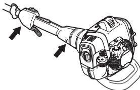
Vibrāciju slāpēšanas sistēma samazina vibrāciju pārvadīšanu starp motora bloku/griešanas aprīkojumu un mašīnas rokturiem.
