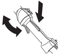
Žr. nuorodas Įjungimas. Užveskite įrenginį ir stipriai spūstelkite akseleratoriaus gaiduką. Atleiskite akseleratorių ir patikrinkite, ar pjovimo įrangą sustoja ir daugiau nejuda. Jei pjovimo įrangą sukasi esant laisvai eigai, patikrinkite karbiuratoriaus laisvosios eigos nustatymus. Žr. nuorodas Priežiūra.
