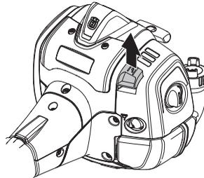
Nuimkite oro filtro dangtelį ir išimkite filtrą. Švariai išpūskite suspaustu oru.
