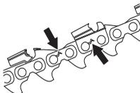
Võrdle ketti uue ketiga, et määrata, kuivõrd kulunud see on. Kui löikehammade pikkus on ainult 4 mm, tuleb kett uuega asendada.
