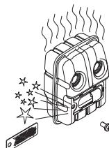
U tlumiče zvuku bez katalyzátoru je zapotřebí sítko čistit a eventuálně vyměnit jednou tydně. U tlumiče zvuku s katalyzátorem je zapotřebí sítko kontrolovat a eventuálně čistit jednou měsíčně. **Poškozenou sítku je nutno vyměnit.**
