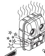
W tłumikach bez katalizatora siatka przeciwiskrowa powinna być czyszczona lub wymieniana raz w tygodniu. W tłumikach z katalizatorem należy sprawdzać i ewentualnie czyszczyć siatkę raz w miesiącu. **Uszkodzoną siatkę należy wymienić.**
