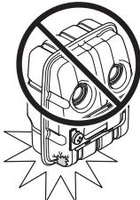
Pravidelne kontrolujte, či je tlmič výfuku pevne pripevnený k motoru.
