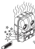
Zachytávač tlmiča výfuku bez katalyzátora je potrebné raz za týždeň vyčistiť alebo ho v prípade potreby vymeniť. Zachytávač tlmiča výfuku s katalyzátorom sa musí kontrolovať a v prípade potreby raz za mesiac vyčistiť. **Ak je zachytávač poškodený, treba ho vymeniť.**
