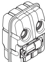
A száraz és meleg klímájú országokban nagyobb a tűzveszély. Ezért az ide szállított berendezéseket úgynevezett szikrafogóhálóval látjuk el. Ellenőrizze, hogy az Ön gépének hangfogóján van-e ilyen háló.
