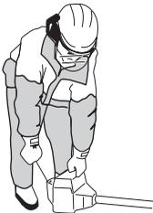
**BEMÆRK!** Anbring ikke nogen legemsdele på den markerede overflade. Kontakt kan medføre forbrændinger af huden eller elektrisk stød, hvis tændhætten er defekt. Anvend altid handsker. Anvend aldrig en maskine med defekt tændhætte.
