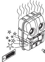
På lyddæmpere uden katalysator bør gnistfangernet rengøres og eventuelt udskiftes en gang om ugen. På katalysatorlyddæmpere skal gnistfangernet kontrolleres og eventuelt rengøres en gang om måneden. **Ved eventuelle skader på gnistfangernet skal det udskiftes.**
