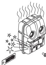
På lyddempere uten katalysator bør nettet rengjøres og eventuelt byttes en gang pr. uke. På katalysatorlyddempere skal nettet kontrolleres og eventuelt rengjøres en gang pr. måned. **Ved ev. skader på nettet skal det skiftes ut.**
