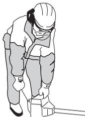
**OBS!** Ikke plasser noen del av kroppen på den markerte flaten. Berøring kan medføre brannskader på huden eller elektrisk støt dersom tennpluggheten er defekt. Bruk alltid hansker. Bruk aldri en maskin med defekt tennplugghette.
