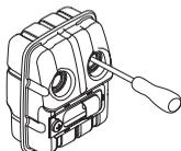
Är din maskins ljuddämpare utrustad med ett gnistfångarnät, skall detta rengöras regelbundet. Ett igensatt nät leder till varmkörning av motorn med allvarlig motorskada som följd.
