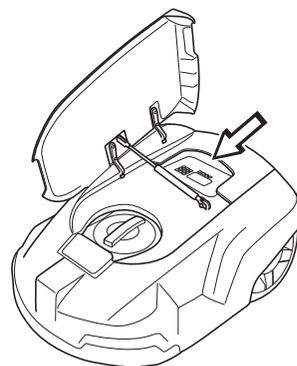
Die Bedientafel besteht aus einem Display und einer Tastatur. Alle Informationen werden auf dem Display angezeigt, und alle Eingaben werden mit den Tasten vorgenommen.
