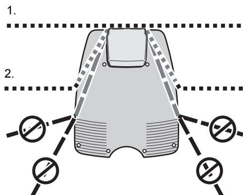
Beim Anschluss an die Ladestation muss das rechte Ende des Begrenzungskabels in die rechte Öffnung und das linke Kabelende in die linke Öffnung eingeführt werden.
