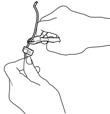
6. Drücken Sie die Kontaktklemmen an den mit A gekennzeichneten Kontaktstiften an der Ladestation fest.
