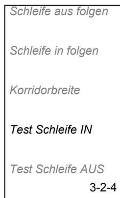
Bei Auswahl dieser Funktion folgt der Mäher direkt dem Begrenzungskabel, S-Kabel 1 oder S-Kabel 2 zur Ladestation – je nachdem, welches Kabel er zuerst findet. Wenn eine Passage vorhanden ist, die vom Mäher nicht durchquert werden kann, wurde der Wert für die *Korridorbreite* zu hoch eingestellt. Wenn für den Mäher *Test Schleife IN* aktiviert ist, bewegt sich das Gerät im maximalen Abstand zum Kabel, den die gewählte *Korridorbreite* zulässt.
