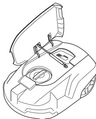
3. Den Drehknopf in die gewünschte Position stellen. Die gewählte Position ist die Markierung am Drehknopf, die sich vor dem Pfeil am Gehäuse befindet.
