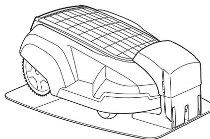
Ein guter Kontakt entsteht, wenn beide Ladebleche des Mähers mittig an den Kontaktblechen der Ladestation anliegen.
