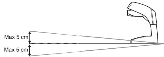
Die Ladestation darf nicht so aufgestellt werden, dass die Platte verbogen wird.
