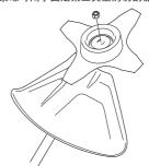
进行安装时,按照与切割锯片旋转方向相反的方向拧紧螺母。 拆卸时,按照与切割锯片旋转方向相同的方向松开螺母。 (小心!螺母为左旋螺纹。)
