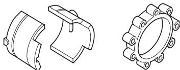
Redno preverjajte stanje elementov za dušenje vibracij. Bodite pozorni na morebitne razpoke in druge deformacije. Prepričajte se, če so dušilni elementi celi in dobro pritrjeni.
