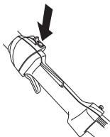
Den Motor starten und kontrollieren, ob der Motor stoppt, wenn der Stopschalter in Stoppstellung geführt wird.
