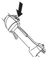
Vžigite motor in preverite, če se ustavi, ko izklopno stikalo potisnete v položaj STOP.
