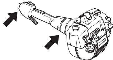
Wenn der Faden falsch gewickelt ist oder die falsche Schneidausrüstung benutzt wird, verstärken sich die Vibrationen. Siehe die Anweisungen unter der Überschrift Schneidausrüstung.
