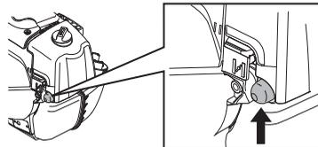
**Choke:** Den Chokehebel in Choke-Lage führen.
