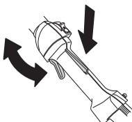
Glej poglavje pod naslovom Vžig. Vžigite stroj in mu dajte polni plin. Izpustite plinsko ročico in se prepričajte, da se rezilni priključek ustavi in obmiruje. Če se rezilni priključek vrti, ko je plinska ročica v legi prostega teka, preglejte nastavitvev uplinjača v prosti legi. Glejte navodila v poglavju Vzdrževanje.
