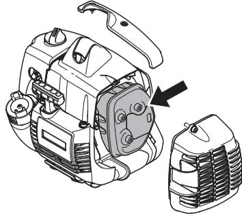
Bestimmte Schalldämpfer sind mit einem speziellen Funkenfangnetz ausgerüstet. Ist Ihr Gerät mit einem derartigen Schalldämpfer ausgestattet, so ist das Netz einmal wöchentlich zu säubern. Dies geschieht am besten mit einer Stahlbürste. Bei Schalldämpfern ohne Katalysator sollte das Netz einmal in der Woche gereinigt und ggf. ausgetauscht werden. Bei
