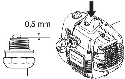
**ACHTUNG!** Stets den vom Hersteller empfohlenen Zündkerzentyp verwenden! Eine ungeeignete Zündkerze kann Kolben und Zylinder zerstören. Dafür sorgen, dass die Zündkerze eine sog. Funkenstörung hat.
