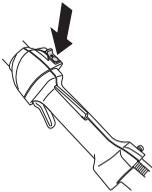
**ACHTUNG!** Der Stoppschalter geht automatisch in die Startstellung zurück. Um ein ungewolltes Starten zu vermeiden, muss bei Montage, Kontrolle und/oder Wartung daher stets die Zündkappe von der Zündkerze entfernt werden.
