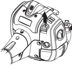
Das Luftfiltergehäuse demontieren und den Filter herausnehmen. Den Filter in warmer Seifenlauge waschen. Dafür sorgen, dass der Filter trocken ist, wenn er wieder montiert wird.
