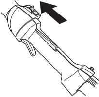
**ACHTUNG!** Der Stoppschalter geht automatisch in die Startstellung zurück. Um ein ungewolltes Starten zu vermeiden, muss bei Montage, Kontrolle und/oder Wartung daher stets die Zündkappe von der Zündkerze entfernt werden.
