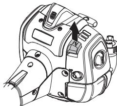
Plaquer la machine contre le sol à l'aide de la main gauche (NOTA! Pas à l'aide du pied!). Saisir ensuite la poignée de démarrage de la main droite et tirer lentement sur le lanceur jusqu'à ce qu'une résistance se fasse sentir (les cliquets d'entraînement grippent), puis tirer énergiquement et rapidement sur le lanceur. **Ne jamais enrouler la corde du lanceur autour de la main.**
