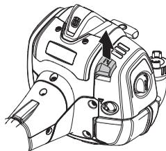
Déposer le capot de filtre et retirer le filtre. Nettoyer le filtre avec de l'eau chaude savonneuse. S'assurer que le filtre est sec avant de le remonter.
