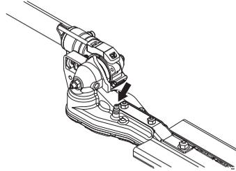
**ACHTUNG!** Das Getriebe darf nicht ganz mit Fett gefüllt werden. Das Fett dehnt sich durch die beim Betrieb des Gerätes entstehende Wärme aus. Ist das Getriebe ganz voll Fett, besteht die Gefahr, dass Dichtungen zerstört werden und Fett austritt.
