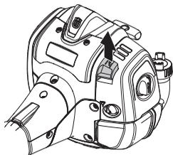
Demonteer het cilinderdeksel en verwijder het filter. Maak het schoon in een warm sopje van water en zeep. Controleer of het filter droog is voor u het terugplaatst.
