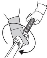
**ACHTUNG!** Bei überschrittener Stopposition sind die Messer blockiert; bitte nicht versuchen, mit dem Schneidwerk in dieser Position zu mähen.
