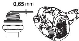
**ACHTUNG!** Stets den vom Hersteller empfohlenen Zündkerzentyp verwenden! Eine ungeeignete Zündkerze kann Kolben und Zylinder zerstören. Dafür sorgen, dass die Zündkerze eine sog. Funkenstörung hat.
