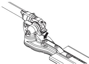
**REMARQUE!** L'engrenage ne doit pas être entièrement rempli de lubrifiant. Le lubrifiant se dilate sous l'effet de la chaleur qui se dégage lors du fonctionnement de la machine. Si l'engrenage est entièrement rempli de lubrifiant, les joints d'étanchéité risquent d'être endommagés, entraînant des fuites de lubrifiant.
