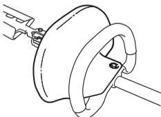
Zorg ervoor dat de handbescherming correct aangebracht is.
