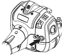
**Choke:** Zet de choke-hendel in de choke-positie.
