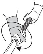
**N.B.!** Wanneer u voorbij de stopstand bent, zijn de messen geblokkeerd, probeer niet te knippen als het snij-aggregaat in deze stand staat.
