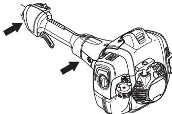
Le système anti-vibrations réduit la transmission des vibrations de l'unité moteur/l'équipement de coupe à l'unité que constituent les poignées.
