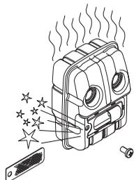
Bei Schalldämpfern ohne Katalysator sollte das Netz einmal in der Woche gereinigt und ggf. ausgetauscht werden. Bei Katalysatorschalldämpfern ist das Netz einmal im Monat zu kontrollieren und evtl. zu reinigen.
