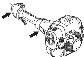
Het trillingdempingssysteem van de machine reduceert het overbrengen van de trillingen van de motoreenheid/snijuitrusting op de handvateenheid van de machine.
