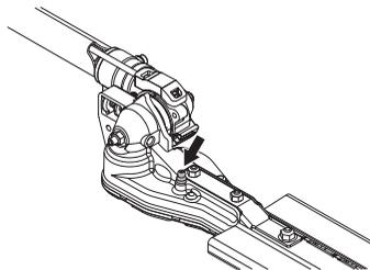
**N.B.!** De versnelling moet niet helemaal met vet gevuld worden. Het vet expandeert door de warmte die onstaat als de machine loopt. Mocht de versnelling helemaal gevuld zijn met vet bestaat het risico van kapotte afdichtingen en lekkage van vet.
