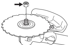
Při montáži utáhněte matice proti směru otáčení řezného vybavení. Při demontáži povolte matice ve směru otáčení řezného vybavení. (POZOR! Matice je levotočivá.) Při povolení a dotahování matice pilového kotouče může dojít k poranění rukou o zuby kotouče. Proto se snáze držet ruku při práci za krytem kotouče. Použijte vždy trubkový klíč s dostatečně dlouhou násadou, abyste toto umožnili. Šípkou na obrázku
