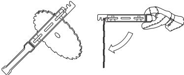
Ellenőrizze, hogy a vágófelszerelés nem sérült-e, nincs-e rajta repedés. A sérült vágófelszerelést mindenki kell cserélni.
