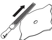
Udržujte řezací kotouč správně natočený! Sledujte naše instrukce a používejte doporučený nástroj k natočení. Nesprávně natočený řezací kotouč zvyšuje riziko uváznutí kotouče a zpětného odrazu a poškození kotouče.
