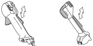
Zkontrolujte, zda se páčka plynu a její pojistka volně pohybují a zda jejich vrátné pružiny fungují správně.
