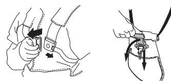
Sprawdź, czy paski szelek są właściwie umieszczone. Po wyregulowaniu szelek i zawiśnięciu maszyny sprawdź, czy działa mechanizm rozpinania awaryjnego.
