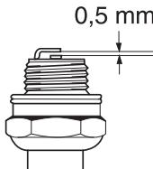
**UPOZORNENIE!** Vždy používajte odporúčaný typ zapáľovacej sviečky! Nesprávna zapáľovacia sviečka môže väzne poškodiť piest/valec. Skontrolujte, či je zapáľovacia sviečka správne nasadená.
