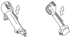
Skontrolujte, či sa páčka plynu a poistná páčka plynu voľne pohybujú a či vrátné pružiny náležite fungujú.
