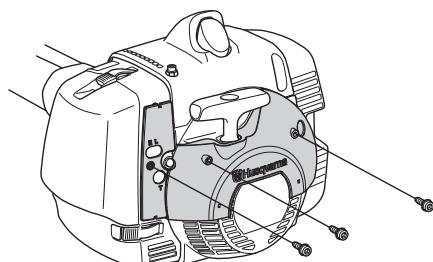
Odstaňte vzduchový filtr a kryt vzduchového filtru ze stroje. Upevněte vzduchový filtr a kryt vzduchového filtru, které jsou součástí zimní soupravy.
