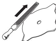
Udržiavajte správny tvar (rozvádzanie) zubov noža! Postupujte podľa našich inštrukcií a používajte odporúčané náradie na vytváranie rozvádzania zubov („šranku“). Akékoľvek nesprávne urobené rozvádzanie zubov pilového kotúča zvyšuje riziko jeho zaseknutia, vzpriečenia alebo spätného rázu a následného poškodenia kotúča.
