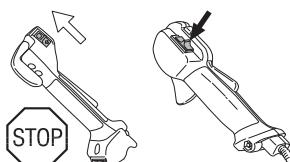
Nastartujte motor a zkonzrolujte, zda se motor zastaví při přesunutí vypínače zapalování do vypnuté polohy.
