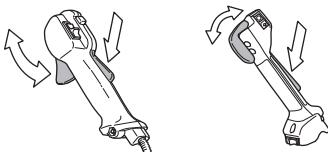
Vyhľadajte si inštrukcie v odseku Štart. Naštartujte stroj a pridajte na plný plyn. Uberte plyn a skontrolujte, či sa rezací nástroj zastavil a či potom zostal státi. Pokiaľ rezací nástroj rotuje aj pri chode stroja na voľnobeh, potom treba
