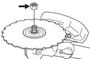
Pri upínaní utáhnite matice v opačnom smere, ako je smer otáčania nástroja. Pri uvoľňovaní otáčajte matice v rovnakom smere, ako je smer otáčania nástroja. (UPOZORNENIE! Matica má ľavý závit.) Pri uvoľňovaní a pri utáhovaní upínacej matice rezáciu noža vzniká riziko poranenia rezaciimi zubami noža. Pri takej práci preto musíte zabezpečiť, aby vaše ruky boli neutrálnie chránené krytom noža. Vždy používajte nástrčkový kľúč z náradia. Šípky na obrázku ukazujú na miesto, kde treba
