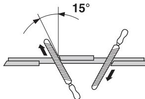
Upravte rozvádzanie zubov. Šírka rozvádzania má byť 1 mm.
