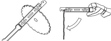
Skontrolujte rezací kotúč, či na ňom nie sú viditeľné známky poškodenia alebo trhliny. Poškodený rezací nástroj treba vždy vymeniť.
