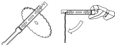
Skontroluj, czy narzędzia tnące nie są uszkodzone bądź pęknięte. Uszkodzone narzędzia tnące należy wymienić na nowe.
