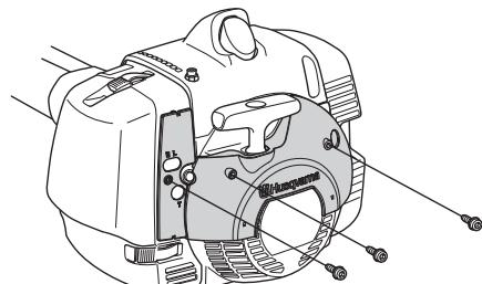
Odstráňte zo stroja vzduchový filter a kryt vzduchového filtra. Nasadte vzduchový filter a kryt vzduchového filtra dodaný so zimnou súpravou.
