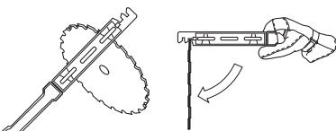
Kontrolujte řezné vybavení co do poškození a vzniku trhlinek. Poškozené řezné vybavení je nutné vždy vyměnit.
