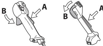
Zkontrolujte, zda při uvolnění pojistiky páčky plynu zapadne páčka plynu do polohy, při které je motor ve volnoběžných otáčkách.
