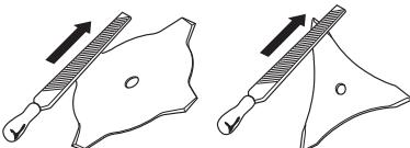
**VIGYÁZAT!** A meggörbült, ferde, megrepedt, vagy egyéb módon meghibásodott pengét cserélje le. Soha ne próbálja kiegyenesíteni a ferde pengét, hogy azt újra használhassa. Csak eredeti, előírt típusú pengéket használjon.
