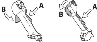
Presvedčte sa, či je ovládanie plynu zablokované pri nastavení na voľnobeh, keď je poistná páčka plynu uvoľnená.
