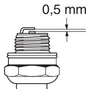
**VAROVÁNÍ!** Vždy používejte doporučený typ zapalovacích svíček! Použití jiného typu zapalovacích svíček by mohlo poškodit píst či válec. Dbejte na to, aby svíčka měla tzv. radiové odrušení.
