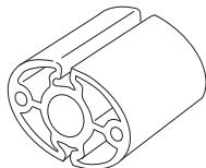
Pravidelne kontrolujte tlmiče vibrácií, či nie sú prasknuté alebo deformované. Skontrolujte, či nie je tlmič vibrácií poškodený a či je bezpečne pripojený.
