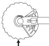
Podczas odkręcania i przykręcania nakrętki ostrza tnącego zawsze istnieje ryzyko skażenia się o zęby ostrza tnącego. Należy zatem pamiętać, aby podczas wykonywania tej czynności ręka osłonięta była przez osłonę ostrza. Aby było to możliwe, używaj zawsze klucza nasadowego z rękojeścią o odpowiedniej długości. Strzałka na rysunku wskazuje obszar,
