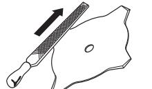
Håll korrekt skräckning på sågklingen! Följ våra instruktioner och använd rekommenderat skräckverktyg.
