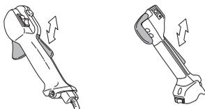
Vérifier que le blocage de l'accélération, la commande d'accélération et leurs ressorts de rappel fonctionnent correctement.
