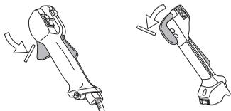
Appuyer sur le blocage de l'accélération et vérifier qu'il revient de lui-même en position initiale quand il est relâché.
