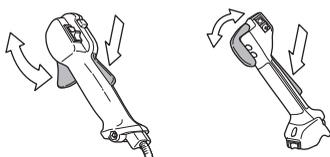
Voir le chapitre Démarrage. Démarrer la machine et donner les pleins gaz. Relâcher l'accélérateur et s'assurer que l'équipement de coupe s'arrête et qu'il reste immobile. Si l'équipement de coupe tourne lorsque l'accélérateur est au régime de ralenti, contrôler le
