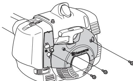
Démonter le filtre à air et le couvercle du filtre à air de la machine. Monter le filtre à air et le couvercle de filtre à air fournis avec le kit spécial hiver.
