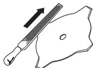
Maintenir un avoyage correct de la lame d'éclaircissage! Suivre nos instructions et utiliser le gabarit d'affûtage
