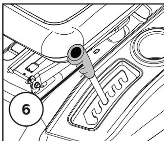
(RU) **6. Быстрый подъем/опускание режущего блока**
