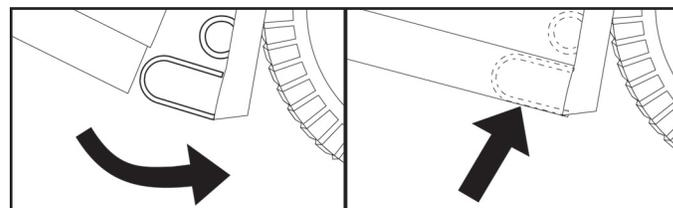
**UWAGA:** W przypadku regulacji wysokości zespołu kosza konieczna może być również regulacja zaczepu sprężynowego kosza. Aby dokonać regulacji, odkręcić nakrętkę (4) i przesunąć zaczep do odpowiedniego otworu w płycie tylnej (1), tak aby zapewnić odpowiednie zamknięcie kosza. Mocno dokręcić śrubę.
