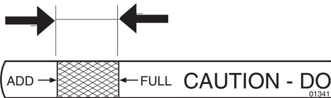
**(CZ)** Hladina oleje musí být mezi oběma značkami na měrce. Není-li tomu tak, doplňte motorový olej SAE 30 až ke značce PLNÁ („FULL“). V zimě (při mrazivém počasí) použijte motorový olej SAE 5W-30.
