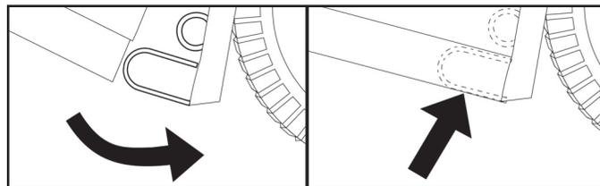
**POZNÁMKA:** nastavená výška zostavy vaku, možno bude treba upraviť pružinovú západku vaku. Pri nastavovaní vyberte maticu (4) a presuňte pružinovú západku vaku do príslušného otvoru v zadnej platni (1) a uistite sa, že zostava vaku sa pevne uzavrie. Maticu pevne dotiahnite.
