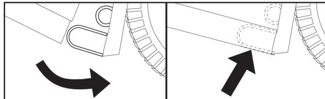
**NAPOMENA:** ako podešavate visinu sklopa košare, možda ćete morati podesiti i opružni zatvarač košare. Za podešavanje, izvadite maticu (4) i pomaknite opružni zatvarač košare u odgovarajuću rupicu na stražnjoj ploči (1) te osigurajte da će sklop košare biti čvrsto zatvoren. Ponovno čvrsto zategnite maticu.
