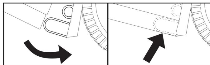
**MEGJEGYZÉS:** Ha a fűgyűjtő szerelvény magasságának beállítása megtörtént, szükség lehet a fűgyűjtő rugós reteszének beállítására. A beállításhoz távolítsa el az anyát (4), és helyezze át a fűgyűjtő rugós reteszt a megfelelő furatba a hátlemez (1), gondoskodva arról, hogy a fűgyűjtő szerelvény biztonságosan zárjon. Húzza meg újra szorosan az anyát.
