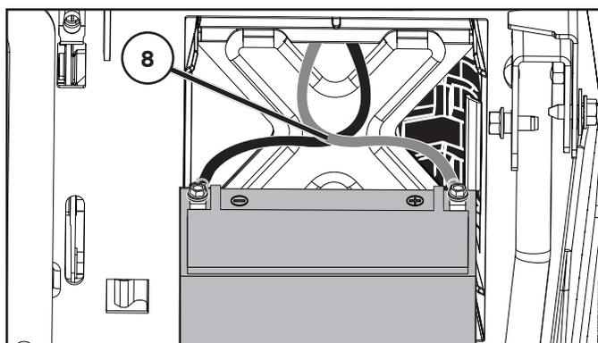
**⚠ UPOZORENJE:** Prvo mora biti povezan pozitivni priključak da se spriječi iskrenje zbog slučajnog dodira s masom.
