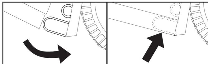
**POZNÁMKA:** Při nastavování výšky sestavy pytlavače může být nutné upravit pérovou západku pytlavače. Chcete-li provést úpravu, odstraňte matici (4) a přešuněte pérovou západku pytlavače do odpovídajícího otvoru zadní desky (1) a zajistěte, aby byla sestava pytlavače bezpečně uzavřena. Pevně utáhněte matici.
