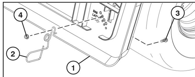
**UWAGA:** Dolna część obudowy pojemnika na trawę musi stykać się z pętlą zapadki, która po zamknięciu obudowy ma za zadanie utrzymać ją na swoim miejscu.
