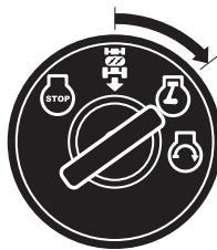
Engine "ON" (Normal användning)
