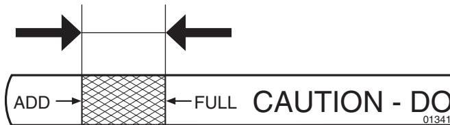
**SE** Oljenivået skall ligge mellom de båda markeringerne på stickan. Om så inte är fallet skall motorolja SAE 30 fyllas till "FULL"-markeringen. Vintertid (under fryspunkten) skall motorolja SAE 5W-30 användas.
