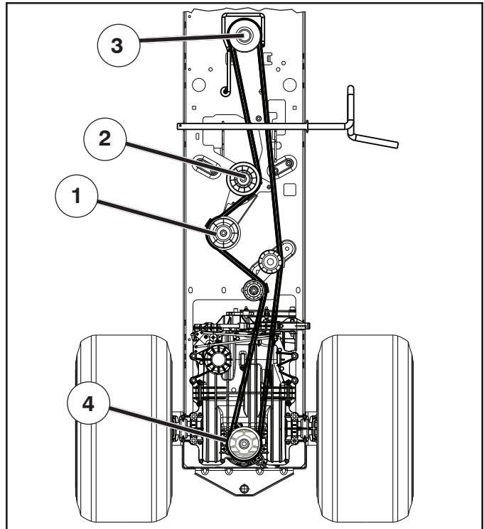
**SE** Montering sker i omvänt ordningsfölgd mot demontering. Kontrollera att remmen ligger innanför samtliga remstyrare. Använd enbart originalrem vid byte!
