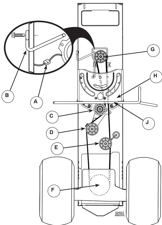
3. Zatáhněte řemen k zadní straně traktoru. Opatrně protahujte řemen dolů kolem chladicího větráku převodovky a na vstupní kladku (F). Řemen musí být uvnitř krytu řemene.
