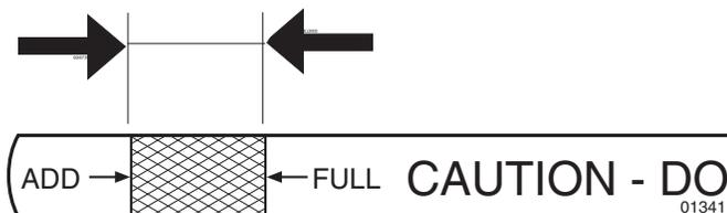
**CZ** Hladina oleje musí být mezi oběma značkami na měrce. Není-li tomu tak, doplňte motorový olej SAE 30 až ke značce PLNÁ („FULL“). V zimě (při mrazivém počasí) použijte motorový olej SAE 5W-30.
