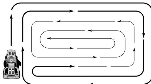
**(CZ)** Při sečení v blízkosti cest, stromů nebo záhonů využijte levé strany žacího ústrojí. Rotující nůž seče pouhých 15 mm od okraje krytu žacího ústrojí.
