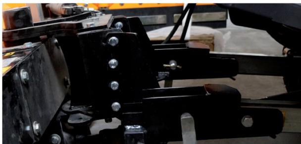
Il est possible d'améliorer l'efficacité du balai en réglant les deux vis de réglage situées sur les côtés gauche et droit du châssis de support. Vérifiez que l'efficacité est optimale lorsque la brosse est inclinée.
