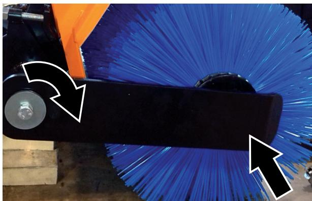
Placera borstarna på vlsen. Varje borste måste vridas 90° jämfört med den föregående (se den övre bilden). Om borstarna kan röra sig fritt demonterar du den monterade flansen, monterar en borste, kontrollerar igen och monterar ytterligare en vid behov.
