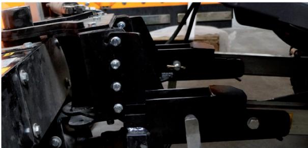
Passen Sie die Kehrleistung mit den beiden Stellschrauben rechts und links vom Trägerrahmen an. Nehmen Sie die Einstellung so vor, dass die beste Kehrleistung bei geneigter Bürste erzielt wird.
