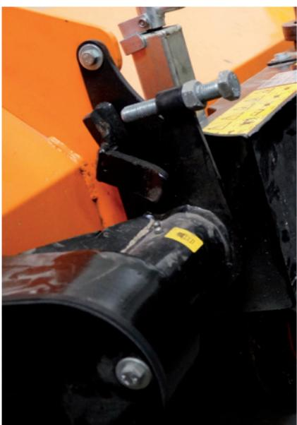
Legen Sie die Höhe der Kehrmaschine über die beiden Einstellräder fest.
