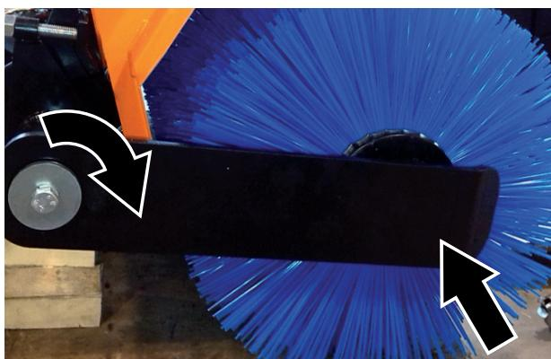
Platzieren Sie die Bürsten auf der Trommel. Drehen Sie jede Bürste gegenüber der vorherigen Bürste um 90° (siehe obere Abbildung). Wenn die Bürsten frei beweglich sind, entfernen Sie den montierten Flansch und fügen eine Bürste hinzu. Prüfen Sie erneut die Beweglichkeit der Bürsten, und fügen Sie gegebenenfalls eine weitere Bürste hinzu.
