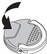
**WAŻNE!** Należy zawsze wymieniać zużyty lub uszkodzony korek.
