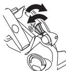
Uchopte přední rukojeť levou rukou a přitlačte pilu k zemi. Uchopte rukojeť startovací šňůry pravou rukou a pomalu ji vytahujte, dokud nepocítíte odpor (když zaskočí západky startéru), a poté silně a rychle zatáhněte, dokud motor
