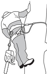
Przemieszczając pilarkę z jednego punktu zamocowania do innego, operator musi zapewnić, że jest ona zabezpieczona w nowej pozycji przed zwolnieniem jej z poprzedniego punktu zamocowania.
