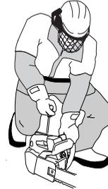
**UWAGA!** Nie wyciągaj linki rozrusznika całkowicie i nie puszczaj jej nagle, gdy jest wyciągnięta. Może to spowodować uszkodzenie maszyny.
