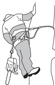
Ha a kezelő át szeretné helyezni a láncfűrész az egyik csatlakoztatási pontról a másikra, akkor előbb rögzítenie kell a fűrész az új helyen, mielőtt az előző csatlakoztatási pontról lecsatolná.
