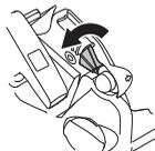
Fogja meg az első fogantyút bal kézzel, és nyomja a láncfűrész talajhoz. Fogja meg az indítófogantyút, húzza ki lassan jobb kézzel az indítózinórt, amíg ellenállást nem érez (az indítófogak beakadnak), majd húzza meg erősen és gyorsan. **Soha ne tekerje rá a kezére az indítózinórt.**
