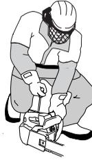
**NEZABUDNITE!** Šnúru štartéra nevyťahujte naplno a nepúšťajte držadlo štartéra pri plnôm vyťahnutí šnúry. Môže to poškodiť stroj.
