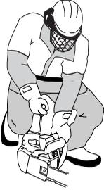
**UWAGA!** Nie wyciągaj linki rozrusznika całkowicie i nie puszczaj jej nagle, gdy jest wyciągnięta. Może to spowodować uszkodzenie maszyny.
