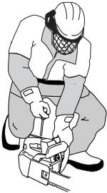
**VAROVÁNÍ!** Nevytahujte celou délku lanka startéru, nepouštějte startovací madlo a nenechávejte plně vytažené lanko samovolně navíjet. To by mohlo stroj poškodit.
