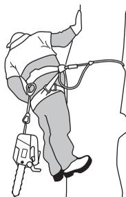
Pokud je pila přemísťována z jednoho přípojovacího bodu do druhého, je třeba se ujistit, že je zajištěna v nové poloze předtím, než bude odpojena od předchozího přípojovacího bodu.
