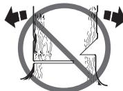
Doporučujeme používat lištu delší než je průměr stromu, abyste mohli provést hlavní řez a směrový zářez vždy jediným
