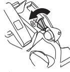
Chwyć za uchwyt przedni lewą ręką i przyciśnij pilarkę do podłoża. Chwyć prawą ręką uchwyt rozrusznika i pociągnij linkę rozrusznika wolno do oporu (do momentu załapania trybów rozrusznika), a następnie pociągnij mocno i szybko. **Nigdy nie owijaj linki rozrusznika wokół dłoni.**
