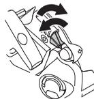
Uchopte predné držadlo ľavou rukou a pritlačte reťazovú pílu k zemi. Uchopte držadlo štartéra pravou rukou a pomaly vyťahujte šnúru štartéra, až kým budete cítiť odpor (západky štartéra sa uvádzajú do činnosti), a potom ťahajte pevne a rýchlo, kým motor naštartuje. **Štartovaciu šnúru si nikdy neomotávajte okolo ruky.**
