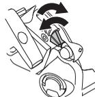
Chwyć lewą ręką uchwyt przedni i przyciśnij pilarkę do podłoża. Chwyć prawą ręką uchwyt rozrusznika i powoli wyciągnij linkę rozrusznika do oporu (do momentu załapania trybów rozrusznika), a następnie pociągaj mocno i szybko do
