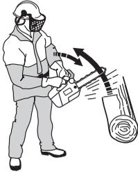
Bei weniger kräftigen Rückschlägen oder wenn sich der Rückschlagbereich in der Nähe des Anwenders befindet, wird die Kettenbremse mit der linken Hand manuell betätigt.
