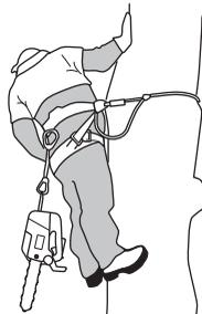
Bei Wechsel der Befestigungsöse sollte der Sägenführer sicherstellen, dass die Säge zuerst in der neuen Position gesichert ist, bevor die vorherige Sicherung gelöst wird.
