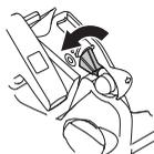
Primite prednji ročaj z levo roko in potisnite motorno žago na tla. Primite zaganjalno ročico z desno roko in potegnite zaganjalno vrstico počasi navzven, tako dolgo da začutite odpor (ko začne vžig prijemati), potem pa potegnite hitro in močno. **Vžigalne vrvice nikoli ne navijajte okoli zapestja.**
