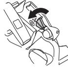
Den vorderen Griff mit der linken Hand umfassen. Mit dem rechten Fuß in den hinteren Griff treten und die Motorsäge gegen den Boden drücken. Den Startgriff mit der rechten Hand fassen und das Startseil bis zum ersten Widerstand (die Starterklinken rasten ein) langsam herausziehen, danach das Seil schnell und kraftvoll herausziehen. **Das Startseil niemals um die Hand wickeln.**
