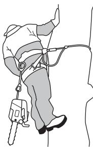
Sae kinnitamisel ühest kinnituspunktist teise peab operaator veendumata, et saag on enne vana kinnituse avamist uude kohta kinnitatud.
