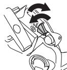
Võtke vasaku käega kinni eesmisest käepidemest ja suruge kettsaagi vastu maapinda. Võtke parema käega kinni starteri käepidemest ja tömmake starteri trossi aeglasealt välja, kuni tunnete takistust (starteri pörklingid rakenduvad), seejärel tömmake tugevalt ja kiirelt, kuni mootor käivitub.
