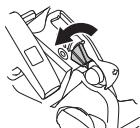
Võtke vasaku käega kinni eesmisest käepidemest ja suruge kettsaagi maapinna poole. Võtke starteri pidemest parema käega kinni ja tömmake käivitusnööri aeglasealt, kuni tunnete
