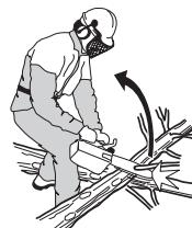
Saetav puu peab olema kontrolli all. Kui te saete väikseid ja kergeid puutükke, võivad need jäädä saeketti kinni ja paiskuda teie vastu. See võib ka mitte ohtlike kahjustusi tekitada, aga siiski ehmatada ja te võite kaotada kontrolli sae üle. Ärge saagige virna või oksi hunnikus, võtke nad eraldi ette. Saagige ainult ühte tüve või oksa korraga. Võtke lahtisaetud tükid ära ja kontrollige, et teie töökoht oleks kogu aeg korras ja jalgealune kindel.
