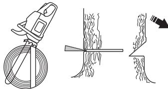
Der Fällschnitt soll parallel zur Kerbschnittlinie abschließen, so dass der Abstand zwischen beiden Schnitten mindestens 1/10 des Stammdurchmessers beträgt. Der nicht durchgesägte Teil des Stamm wird als Brechmaß bezeichnet.
