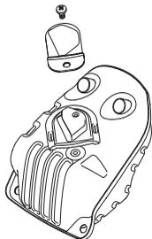
**POZOR!** Med uporabo postane dušilec zelo vroč. To velja tudi v primeru prostega teka. Bodite pozorni na nevarnost požarov, posebej, ko delate v bližini vnetljivih substanc in/ali plinov.
