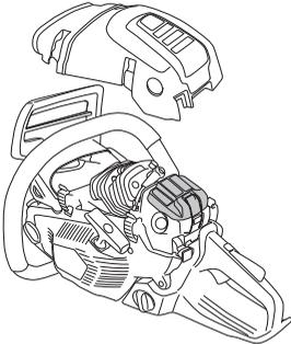
Eine gründlichere Reinigung erfolgt durch Auswaschen des Filters in Seifenwasser.
