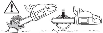
Wenn die Möglichkeit vorhanden ist (= kann der Stamm gedreht werden?), sollte der Stamm zu 2/3 durchgesägt werden.
