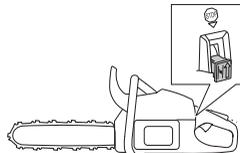
**ACHTUNG!** Der Start/Stopschalter geht automatisch in die Betriebsposition zurück. Um ein ungewolltes Starten zu vermeiden, muss bei Montage, Kontrolle und/oder Wartung daher stets die Zündkappe von der Zündkerze entfernt werden.
