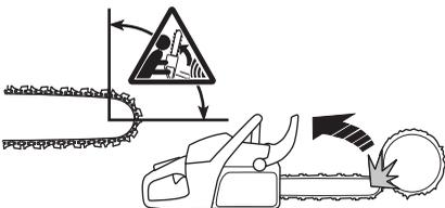
Ein Rückschlag ist immer in Richtung der Führungsschiene gerichtet. Am häufigsten erfolgt der Stoß von Motorsäge und Führungsschiene nach oben und nach hinten zum Anwender. Rückschläge erfolgen aber auch in andere Richtungen, je nachdem in welcher Stellung sich die Motorsäge in dem Augenblick befindet, in dem der Rückschlagbereich mit einem Gegenstand in Berührung kommt.
