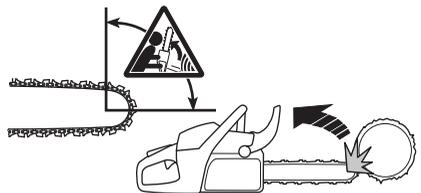
Das Sägen mit der Unterseite der Führungsschiene, d.h. von der Oberseite des Baumstammes nach unten, wird als Sägen mit ziehender Kette bezeichnet. Die Motorsäge wird zum Baumstamm hingezogen und die Vorderkante des Motorsägenkörpers fungiert als natürliche Stütze am Stamm. Beim Sägen mit ziehender Kette hat der Anwender eine bessere
