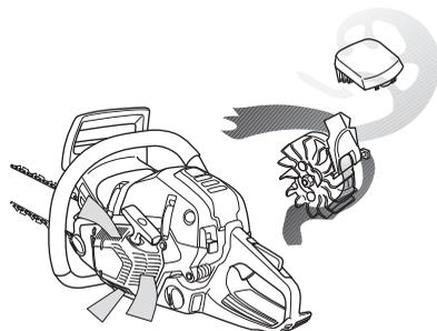
**POMEMBNO!** Učinkovitost centrifugalnega čiščenja je odvisna od rednega vzdrževanja in nege. Očistite dovod zraka v zaganjalnik, krila ventilatorja, prostor okrog ventilatorja, dovodno cev in komoro uplinjača.
