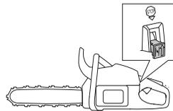
**PAZITE!** Stikalo za zagon/zaustavitev se samodejno povrne v začetni položaj. Da bi preprečili neželeni zagon morate zaganjalno varovalko odstraniti iz svečke, ko stroj ni nadzorovan.
