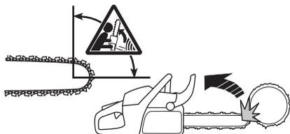
Žaganje s spodnjim robom meča, to se pravi od zgoraj navzdol, se imenuje žaganje na vleč. V tem primeru žago vleče proti deblu, njeno težo pa nosi spodnji rob meča. Ta način žaganja omogoča uporabniku boljši nadzor žage in položaja odbojnega območja meča.
