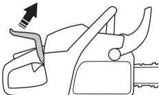
Bær eller heng aldri saken i bøylene! Det kan skade mekanismen og sette kjedebremsen ut av funksjon.
