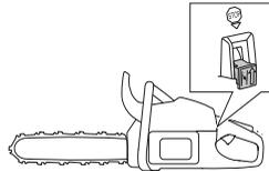
**OBSERVERA!** Start/Stop kontakten återgår automatiskt till körläge. För att undvika ofrivillig start, måste därför alltid tändhatten avlägsnas från tändstiftet när maskinen inte är under uppsikt.
