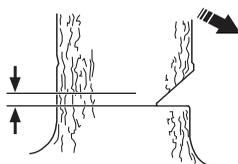
Sätt i barkstödet (om något är påmonterat) bakom brytmånen. Såga med fullgas och för sågkedjan/svärdet sakta in i trädet. Var observant på om trädet rör sig i motsatt riktning till vald fallriktning. Sätt i en fällkil eller ett brytjärn i fällskåret så snart skärdjupet tillåter.
