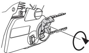
Uuden ketjun kireys on tarkastettava usein ketjun sisäänajon aikana. Tarkasta ketjun kireys säännöllisesti. Oikein kiristetty ketju takaa hyvän leikkuutehon ja pitkän kestoian.
