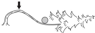
Afgør, hvordan du på den sikreste måde kan frigøre spændingen, og om du kan klare det. Ved særligt komplicerede situationer er den eneste sikre metode helt at undlade at bruge motorsaven og i stedet bruge et spil.
