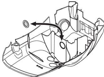
För körning av maskinen i kallt väder eller i lössnö finns en speciell täckkåpa som monteras på startapparathuset.
