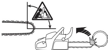
Å sage med sverdets underside, dvs. å sage fra sagobjektets overside og ned, kalles å sage med dragende sagkjede. Da dras motorsagen mot treet, og motorsagkroppens forkant blir en naturlig støtte mot stammen. Saging med dragende sagkjede gir brukeren bedre kontroll over motorsagen og over hvor sverdets kastrisikosektor befinner seg.
