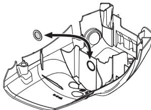
Før brug af maskinen i koldt vejr eller i pulversne kan der monteres et særligt dæksel på startaggregatet. Dette
