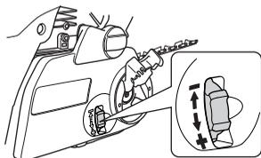
Kæden er korrekt spændt, når den ikke hænger slapt ned på sværdets underside og stadig kan trækkes rundt med hånden. Spænd sværdmøtrikkerne fast med kombinøglen, samtidig med at sværdspidsen holdes opad.
