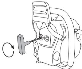
Visse lyddæmpere er udstyret med et specielt gnistfangernet. Hvis din maskine er udstyret med en sådan lyddæmper, bør nettet rengøres en gang om ugen. Dette gøres bedst med en stålborste. Et tilstoppet net medfører, at motoren kører varm med alvorlig motorskade til følge.
