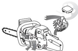
**VIGTIGT!** For at bevare centrifugalrensningens funktion skal man udføre kontinuerlig pleje og vedligeholdelse. Rens startaggregatets luftindtag, svinghjulets ventilatorflanger, området omkring svinghjulet, indsugningsrøret og karburatorrummet.
