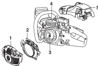
Puhdista jäähdytysjärjestelmä harjalla kerran viikossa, vaikeammissa käyttöolosuhteissa useammin. Likainen tai tukkeentunut jäähdytysjärjestelmä johtaa koneen ylikuumentumiseen, josta on seurauksena sylinterin ja männän vaurioituminen.
