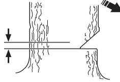
Placer barkstøtten (hvis den er monteret) bag brudpunktet. Sav med fuld gas, og før savkæden/sværdet langsomt ind i træet. Vær opmærksom på, om træet bevæger sig i modsat retning i forhold til den valgte faldretning. Sæt en fældeklie i eller et brækjern i fældesnittet, så snart snitdybden tillader det.
