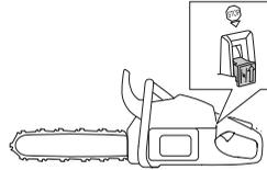
OBS! Start/Stopp-kontakten går automatisk tilbake til kjørestilling. For å unngå ufrivillig start, må tennpluggetten derfor alltid fjernes fra tennpluggen når maskinen ikke er under tilsyn.
