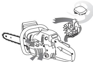
**TÄRKEÄÄ!** Keskipakoispuhdistuksen tehon säilyttämiseksi on huolehdittava säännöllisestä huollosta. Puhdista käynnistimen ilmanottoaukot, vauhtipyörän tuuletinsiivet, vauhtipyörän ympäristö, imuputki ja kaasutintila.
