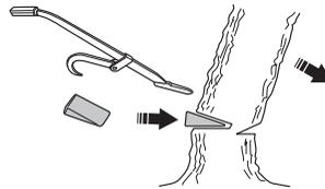
Vi anbefaler bruk av en sverdlengde som er større enn trets diameter, slik at hoved- og styreskår kan utføres med et såkalt "enkelt sagskår". Se anvisninger under overskriften Tekniske data ang. hvilke sverdlengder som anbefales for din motorsagsmodell.
