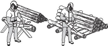
**Stokken ligger på bakken.** Det er ingen fare for at sagkjedet skal klemmes fast eller at sagobjektet skal splintres. Det er imidlertid stor fare for at sagkjedet treffer bakken etter gjennomsaging.
