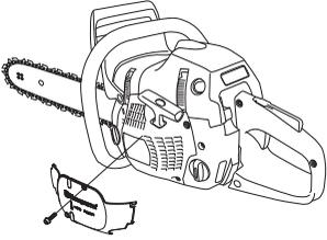
**VIGTIG!** Hvis der er monteret et spesielt vintersett eller det er gjort noe for å heve temperaturen, må maskinen omstilles til normal innstilling når den brukes i normale temperaturforhold. Ellers risikerer man overoppheting med alvorlige motorskader som resultat.
