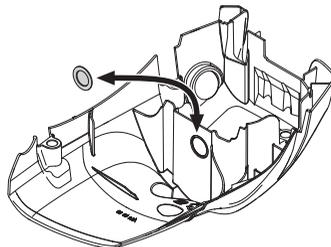
Ved bruk av maskinen i kulde eller puddersnø finnes også et spesielt beskyttelseslokk som monteres på
