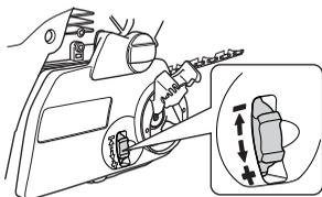
Ketjun kireys on oikea, kun se ei roiku löysällä terälevyn alapuolella ja liikkuu kevyesti käsin pyöritettäessä. Kiristä terämutterit yhdistelmäavaimella pitäen samalla terälevyn kärkeä ylhäällä.
