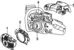
Rengjør kjølesystemet med en børste en gang i uken, ved vanskelige forhold oftere. Et tilsmusset eller tett kjølesystem fører til at maskinen overopphetes, noe som forårsaker skader på sylinder og stempel.
