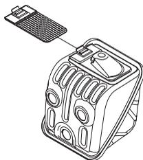
Lyddæmperen er beregnet til at dæmpe lyd-niveauet og til at lede udstødning-gasserne væk fra brugeren. Udstødning-gasserne er varme og kan indeholde gnister, som kan forårsage brand, hvis udstødning-gasserne rettes mod et tørt og brændbart materiale.
