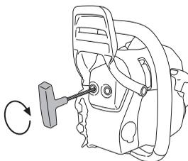
Noen lyddempere er utstyrt med et spesielt gnistfangernett. Hvis maskinen er utstyrt med en slik lyddemper, bør nettet rengjøres en gang i uken. Dette gjøres enklest med en stålborste. Et tilstoppet nett fører til at motoren går varm med alvorlig motorskade som følge.
