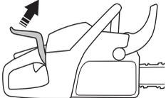
Bær eller hæng aldrig saven i bøjlen! Det kan skade mekanismen og sætte kædebremser ud af funktion.
