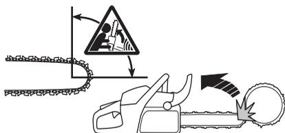
At save med sværdets underside, dvs. save fra objektets overside og ned, kaldes at save med trækkende savkæde. Da trækkes motorsaven mod træet og motorsavskroppens forkant bliver en naturlig støtte mod stammen. Savning med trækkende savkæde giver brugeren bedre kontrol over motorsaven, og man ved, hvor sværdets kastrisikozone befinder sig.
