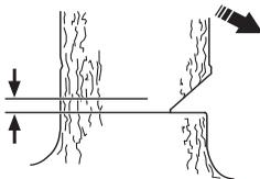
Sett i barkstøtten (hvis en slik er montert) bak brytekannten. Sag med full gass og tør sagkjedet/sverdet sakte inn i treet. Vær på vakt mot at treet beveger seg i motsatt retning av det som er valgt som fallretning. Sett i en fellekile eller et brytejern i hovedskåret så snart skjæredybden tillater det.
