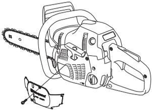
**TÄRKEÄÄ!** Jos koneeseen on asennettu erityinen talvivarustus tai sen käyntilämpötilaa on nostettu, täytyy varustus poistaa ja säädöt palauttaa entiselleen, ennen kuin konetta aletaan käyttää normaaleissa lämpötiloissa. Muussa tapauksessa moottori voi ylikuumeta, mistä seuraa vakavia moottorivaurioita.
