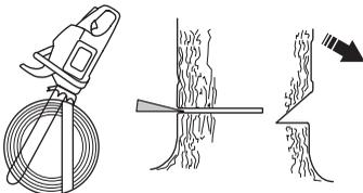
Hovedskåret skal avsluttes parallelt med styreskårlinjen slik at avstanden mellom dem er minst 1/10 av stammens diameter. Den delen av stammen som ikke er gjennomsgått, kalles brytekannt.
