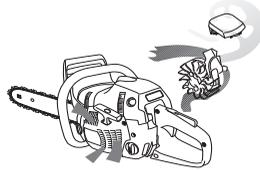
**VIGTIG!** For å opprettholde sentrifugalrensingens funksjon, må den rengjøres og vedlikeholdes kontinuerlig. Rengjør luftinntaket til startmotoren, vifteskovlene på svinghjulet, rommet rundt svinghjulet, inntaksrøret og forgasserrommet.
