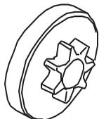
Kontrollér regelmæssigt slitageniveauet for kædedrivhjulet. Udskift det, hvis det er unormalt slidt. Kædedrivhjulet skal udskiftes ved hver savkædeudskiftning.
