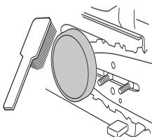
Kontroller jevnlig at bremsebåndet er minst 0,6 mm tykt på det mest slitte stedet.
