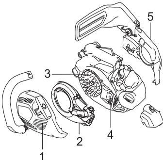
Rengjør kjølesystemet med en børste en gang i uken, ved vanskelige forhold oftere. Et tilsmusset eller tett kjølesystem fører til at maskinen overoppheites, noe som forårsaker skader på sylinder og stempel.
