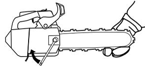
På et nytt kjede må kjedespenningen kontrolleres ofte til kjedet er kjørt inn. Kontroller kjedespenningen regelmessig. Riktig kjede betyr god skjærekapasitet og lang levetid.
