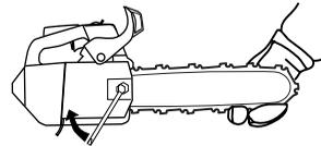
På en ny kæde skal kædestramningen kontrolleres ofte, indtil kæden er kørt til. Kontrollér kædestramningen regelmæssigt. Korrekt kæde betyder god skærekapacitet og lang levetid.
