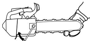
Uuden ketjun kireys on tarkastettava usein ketjun sisäänajon aikana. Tarkasta ketjun kireys säännöllisesti. Oikein kiristetty ketju takaa hyvän leikkuutehon ja pitkän kestoian.
