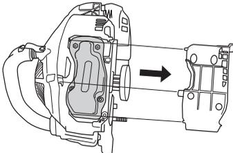
Lossa skruvar och muttrar. Tag loss och kontrollera att ljuddämparen är hel.
