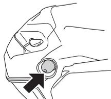
**Aizdedze:** Virziet stop slēdzi uz iedarbināšanas pozīciju.
