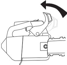
Skruva svärdsmuttern och tag bort kopplingskåpan (kedjebromsen). Avlägsna transportskyddet.
