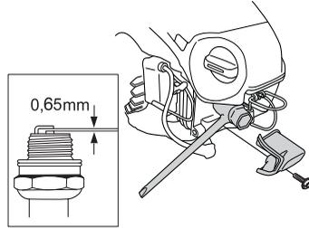
Observera! Använd alltid rekommenderad tändstiftstyp! Felaktigt tändstift kan förstöra kolv/cylinder. Se till att tändstiftet har s.k. radioavstörning.
