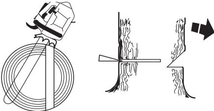
Hovedskåret skal avsluttes parallelt med styreskårlinjen slik at avstanden mellom dem er minst 1/10 av stammens diameter. Den delen av stammen som ikke er gjennomsgad, kalles brytekant.
