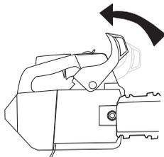
Ruuvaa terälevyn mutteri irti ja irrota kytkinkotelo (ketjujarru). Poista kuljetussuoja.
