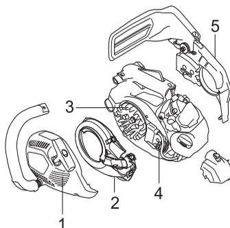
Rens kølesystemet med en børste en gang om ugen, under støvfyldte forhold oftere. Et snavset eller tilstoppet kølesystem medfører overopvarmning af maskinen med skader på cylinderen og stemplet til følge.
