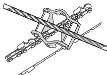
Se anvisningerne i afsnittet Tekniske data for at få oplysninger om, hvilke data der gælder ved filning af din motorsavs savkæde.
