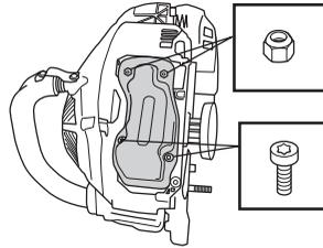
Ljuddämparen är utformad för att dämpa ljudnivån och för att leda avgaserna bort från användaren. Avgaserna är heta och kan innehålla gnistor vilka kan orsaka brand om avgaserna riktas mot ett torrt och brännbart material.
