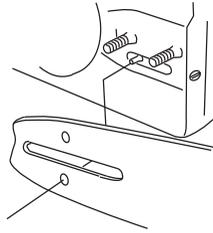
Spänn kedjan genom att med hjälp av kombinyckeln skriva kedjespännarskraven medurs. Se anvisningar under rubrik Sträckning av sågkedjan.
