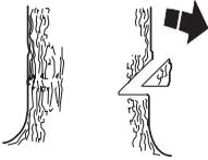
Retningsnitdybden skal være 1/4 af stammens diameter, og vinklen mellem over- og undersnit skal være mindst 45°.
