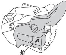
Montér sværdet over sværdboltene. Placér sværdet i dets bagerste stilling. Placér kæden over kædedrivhjulet og i sværdsporet. Begynd på sværdets overside.
