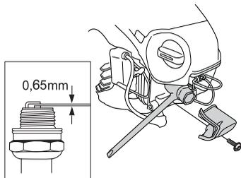
Bemærk! Brug altid anbefalet tændrørstype! Forkert tændrør kan ødelægge stempel/cylinder. Kontrollér, at tændrøret har såkaldt radiostøjdæmpning.
