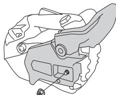
Asenna terälevy teräpultteihin. Aseta terälevy takimmaiseen asentoonsa. Aseta ketju ketjupyörälle ja terälevyn ohjausraan. Aloita terälevyn yläpuolelta.
