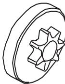
Kontroller slitasjenivået på kjededrivhjulet regelmessig. Skift det hvis det er unormalt slitt. Kjededrivhjul skal skiftes hver gang sagkjedet skiftes.
