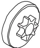
Tarkasta säännöllisesti ketjupyörän kuluneisuus. Vaihda, jos se on epätavallisen kulunut. Ketjupyörä on vaihdettava aina teräketjun vaihdon yhteydessä.
