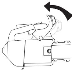
Kruvige saelati mutter maha ja eemaldage sidurikate (ketipidur). Eemaldage transpordikaitse.
