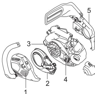
Puhasta jahutussüsteemi kord nädalas harjaga, raskete tööolude puhul tihedamini. Määrdund või ummistunud jahutussüsteemi puhul kuumeneb seade üle, mis vigastab silindrit ja kolbi.
