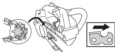
Tarkasta, että hammaslenkkien teräsarmat ovat eteenpäin terälevyn yläpuolella.
