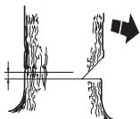
Sätt i barkstödet (om något är påmonterat) bakom brytmänen. Såga med fullgas och för sågkedjan/svärdet sakta in i trädet. Var observant på om trädtoppen rör sig i motsatt riktning till vald fallriktning.
