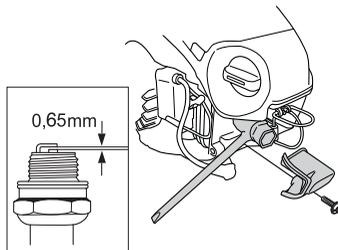
Bemerk! Bruk alltid anbefalt type tennplugg! Feil tennplugg kan ødelegge stempel/sylinder. Påse at tennpluggen har såkalt radiostøyfilter.
