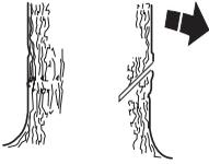
Sav derefter undersnittet, så det afsluttes præcis, hvor oversnittet slutter.
