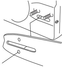
Spænd kæden ved at bruge kombinøglen til at skrue kædestrammerskruen med uret. Kæden skal strammes til, så den ikke hænger slapt ned på sværdets underside. Se anvisningerne i afsnittet Stramning af savkæden.
