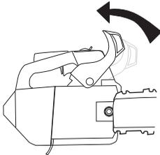
Skrut ut sverdmutteren og demonter kopplingsdekslet (kjedebremsen). Fjern transportbeskyttelsen.
