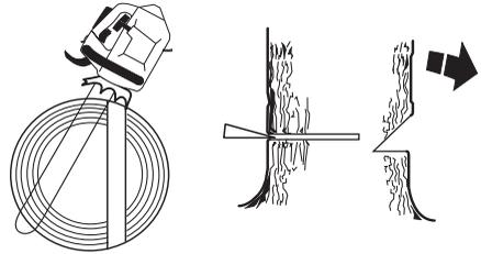
Fældesnittet skal afsluttes parallelt med retningsnitlinjen, så afstanden mellem de to er mindst 1/10 af stammens diameter. Den ikke gennemsaveede del af stammen kaldes brudpunktet.
