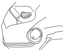
Lietojiet to pašu procedūru kā ar aukstu motoru, tikai neiestādiet droselēvārstu choke pozīcijā.
