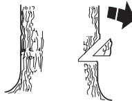
Abiem griezumumiem kopumā jāšķēl apmēram 1/4 stumbrā diametru, veidojot apmēram 45 grādu leņķi.
