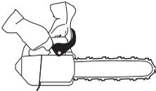
Gi full gass og aktiver kjedebremsen ved å vri venstre håndledd mot kastbeskyttelsen. Ikke slipp det fremste håndtaket. **Kjedet skal stanse umiddelbart.**
