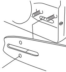
Stram kjedet ved å skru kjedestrammerskruen med klokken med kombinøkkelen. Kjedet skal strammes til det ikke henger ned på undersiden av sverdet og fremdeles kan dras lett rundt for hånd. Se anvisninger under overskriften Stramming av sagkjedet.
