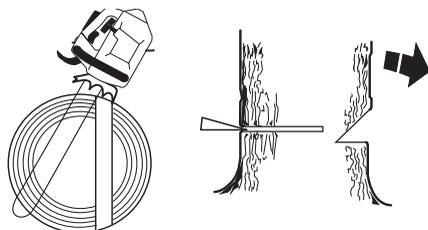
Nogrieziet gāšanas griezumam paralēli ar gāšanas virziena griezuma līniju, atstājot atstarpi, kas atbilst 1/10 stumbra diametram. Stumbra nepārgrieztu daļu sauc par laušanas strēmele.
