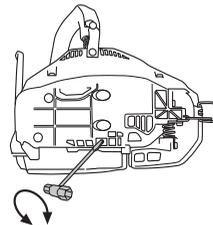
Oljetanken ska vara nästan tom när bränslet är slut. Fyll oljetanken varje gång du förser sågen med nytt bränsle.
