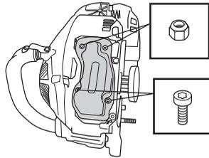
Lyddemperen er utformet for å dempe lydnivået og for å lede avgassene bort fra brukeren. Avgassene er varme og kan inneholde gnister som kan forårsake brann hvis gassene rettes mot et tørt og brennbart materiale.
