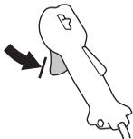
Appuyer sur le blocage de l'accélération et vérifier qu'il revient de lui-même en position initiale quand il est relâché.
