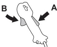
Vérifier d'abord que la commande de l'accélération est bloquée en position de ralenti quand le blocage de l'accélération est en position initiale.
