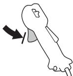
Stiskněte pojistku páčky plynu a zkontrolujte, zda se po uvolnění vrátí do své výchozí polohy.
