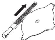
Udržujte řezací kotouč správně natočený! Sledujte naše instrukce a používejte doporučený nástroj k natočení. Nesprávně natočený řezací kotouč zvyšuje riziko uváznutí kotouče a zpětného odrazu a poškození kotouče.
