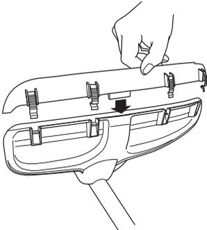
Nastavba krytu jednoducho odmontujete pomocou kombinovaného kľúča (pozri obrázok).
