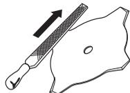
Dopilnuj, aby zęby tarczy tnącej były prawidłowo rozwarte! Postępuj zgodnie z naszymi instrukcjami i stosuj zalecany rozwieracz. Nieprawidłowe rozwarcie zębów tarczy tnącej zwiększa ryzyko jej zakleszczenia się, odbicia oraz uszkodzenia.
