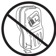
Pravidelne kontrolujte, či je tlmič výfuku pevne pripravený k motoru.
