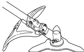
Sprawdź, czy osłona nie jest uszkodzona i czy nie ma śladów pęknięcia. Wymień osłonę, która została uderzona lub jest pęknięta.
