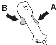
Sprawdź, czy dźwignia gazu jest zablokowana w położeniu biegu jałowego, gdy blokada dźwigni gazu znajduje się w położeniu wyjściowym.
