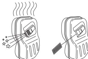
Nagyon fontos, hogy a felhasználó kövesse a kipufogódobra vonatkozó ellenőrzési, karbantartási és szervizelőírásokat. Lásd A gép biztonsági felszerelésének vizsgálatát.
