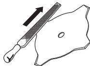
Udržiavajte správny tvar (rozvádzanie) zubov noža! Postupujte podľa našich inštrukcií a používajte odporúčané náradie na vytváranie rozvádzania zubov („šranku“). Akékoľvek nesprávne urobené rozvádzanie zubov pilového kotúča zvyšuje riziko jeho zaseknutia, vzpríečenia alebo spätného rázu a následného poškodenia kotúča.
