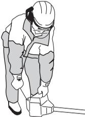
Po nastartování motoru pomocí plynu postupně zvyšujte otáčky motoru. Zkontrolujte, zda motor běží plynule.
