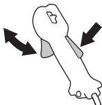
Vyhľadajte si inštrukcie v odseku Štart. Naštartujte stroj a pridajte na plný plyn. Uberte plyn a skontrolujte, či sa rezací nástroj zastavil a či potom zostal stáť. Pokiaľ rezací nástroj rotuje aj pri chode stroja na voľnobeh, potom treba
