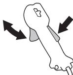
Patrz wskazówki pod rubryką Uruchamianie. Włącz maszynę i dodaj gazu do oporu. Zwolnij dźwignię gazu i sprawdź, czy osprzęt tnący zatrzymał się i nie porusza się. Jeśli osprzęt tnący obraca się, mimo iż dźwignia gazu znajduje się w położeniu biegu jałowego, należy sprawdzić wyregulowanie
