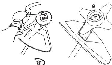
Nylonowy pierścień zabezpieczający nakrętkę przed odwróceniem się nie powinien być starty do tego stopnia, aby można było przykręcić nakrętkę ręcznie. Zabezpieczenie to powinno wymagać siły przykręcania równej co najmniej 1,5 Nm. Po około dziesięciokrotnym przykręcaniu nakrętki należy wymienić ją na nową.
