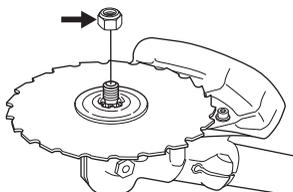
Podczas montażu dokręcaj nakrętkę w kierunku przeciwnym do kierunku obrotów osprzętu tnącego. Podczas demontażu odkręcaj nakrętkę w kierunku zgodnym z kierunkiem obrotów
