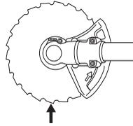
Při povolování a dotahování maticе pilového kotouče může dojít k poranění rukou o zuby kotouče. Proto se snažte držet ruku při práci za krytem kotouče. Použijte vždy trubkový klíč s dostatečně dlouhou násadou, abyste toto umožnili. Šipka na obrázku ukazuje, v jakém rozmezí klíč bude pracovat při povolování nebo utahování maticе.
