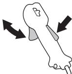
Lásd az Indítás című fejezetet. Kapcsolja be a gépet és adjon teljes gázt. Engedje el a gázszabályozót és győződjön meg róla, hogy a vágófelszerelés leállt és teljesen mozdulatlan. Ha a vágószerszám alapjáratban is forog, ellenőrizze a porlasztó
