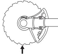
Podczas odkręcania i przykręcania nakrętki ostrza tnącego zawsze istnieje ryzyko skaleczenia się o zęby ostrza tnącego. Należy zatem pamiętać, aby podczas wykonywania tej czynności ręka osłonięta była przez osłonę ostrza. Aby było to możliwe, używaj zawsze klucza nasadowego z rękkojeścią o odpowiedniej długości. Strzałka na rysunku wskazuje obszar, w którym należy operować kluczem nasadowym przy odpowiednio odkręcaniu i dokręcaniu nakrętki.
