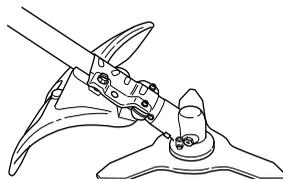
Zkontrolujte, zda kryt není poškozen ani nemá trhlinky. Byl-li kryt vystaven úderu nebo má trhlinky je nutno jej vyměnit.
