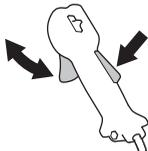
Viz pokyny pod rubrikou Start. Nastartujte stroj a dejte plný plyn. Uvolněte regláž plynu a přesvědčte se o tom, že se řezné vybavení zastavilo a stojí v klidu. Pokud se po převedení regláže plynu do polohy volnoběhu řezné vybavení nadále
