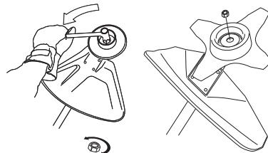
Lukitusmutterin naisonlukitus ei saa olla niin kulunut, että sitä voi ruuvata käsin. Lukituksen on kestettävä vähintään 1,5 Nm. Mutteri on vaihdettava, kun se on ruuvattu kiinni noin 10 kertaa.
