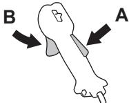
Kontroller at gassregulatoren er låst i tomgangsstilling når gassregulatorsperren er i sin utgangsposisjon.
