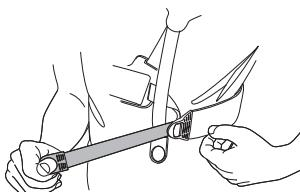
3 Justera axelbanden så att en jämn belastning på axlarna erhålls. Tryck neråt på upphängningskroken för att belasta selen.
