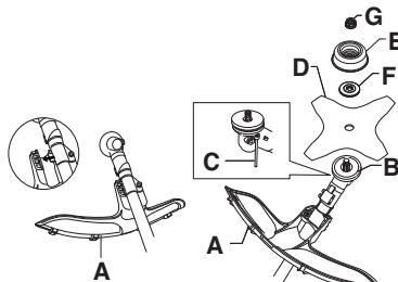
**OBS!** Se till att skyddskappan är demonterad.
