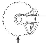
Både når man løsner og når man trekker til mutterne på sagbladet er risikoen til stede at man skader seg på bladets tinner. Påse derfor at hånden befinner seg i ly av bladbeskyttelsen under dette arbeidet. Bruk alltid en pipenøkkel med tilstrekkelig langt skaft for å gjøre dette mulig. Pilen på bildet viser innenfor hvilket område pipenøkkelen skal arbeide ved løsning/tiltrekking av mutteren.
