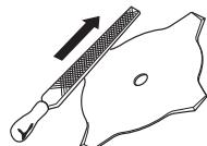
Håll korrekt skräckning på sågklingen! Följ våra instruktioner och använd rekommenderat skräckverktyg. En felaktigt skräckt sågklinga ökar risken för fastlösning och kast samt skador på sågklingen.
