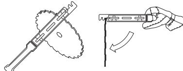
Kontroller skjæreutstyret med henblikk på skader og sprekkdannelse. Skadet skjæreutstyr må alltid skiftes.
