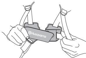
5 Vill man sänka upphängningskroken för t.ex. gräsröjning flyttas upphängningskrokens rem (A) till det nedre fästet på ryggplattan.
