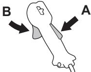
Kontrollera att gasreglaget är låst i tomgångsläge när gasreglagespärren är i sitt ursprungsläge.
