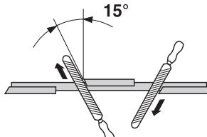
Säädä kouru- ja säätöhampaan korkeusero. Sen on oltava 1 mm.
