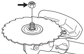
Trekk til mutteren mot skjæreutstyrts rotasjonsretning ved montering. Løsne mutteren i skjæreutstyrts
