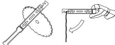
Kontrollera skärutrustningen med avseende på skador och sprickbildning. En skadad skärutrustning ska alltid bytas ut.
