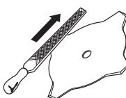
Sørg for, at udlegningen på savklingen er korrekt! Følg vores instruktioner, og brug det anbefaede udleggerværktøj. En forkert udlagt savklinge øger risikoen for fastlåsning og kast samt skader på savklingen.
