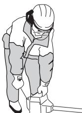
Moottorin käynnistyttyä lisää moottorin nopeutta käyttämällä kaasuliipaisinta vähitellen. Varmista, että moottori käy tasaisesti.
