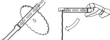
Tarkasta terälaitte vaurioiden ja halkeamien varalta. Vaurioitunut terälaitte on aina vaihdettava.
