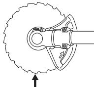
Vid lossdragning och åtdragning av sågklingans mutter finns risk för att skada sig på sågklingans tänder. Se därför till att handen befinner sig i skydd av klingskyddet vid detta arbete. Använd alltid en hylsnyckel med tillräckligt långt skaft för att möjliggöra detta. Pilen på
