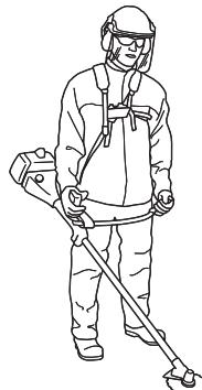
8 Ved arbejde med rydningssav skal den altid hægtes fast i selen. I modsat fald kan du ikke manøvrere rydningssaven sikkert, og dette kan forårsage skade på dig selv eller andre. Brug aldrig en sele med defekt snapudløsning.
