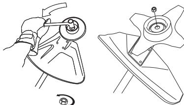
Låsmutterns nylonläsning får ej vara så sliten att den kan skruvas med fingrarna. Läsningen ska hålla minst 1,5 Nm. Muttern ska bytas efter det att den skruvats på ca 10 gånger.
