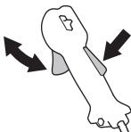
Se anvisningar under rubrik Start. Starta maskinen och ge full gas. Släpp gasreglaget och kontrollera att skärutrustningen stannar och att den förblir stillastående. Om skärutrustningen roterar med gasreglaget i
