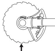
Ved løsning eller fastspænding af savklingens møtrik er der risiko for at skære sig på savklingens tænder. Sørg derfor for, at hånden er beskyttet af klingebeskyttelsen under dette arbejde. Brug altid en topnøgle med tilstrækkeligt langt skaft for at gøre dette muligt. Pilen på billedet viser, inden for hvilket område topnøglen skal bruges ved henholdsvis løsning og fastspænding af møtrikken.
