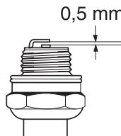
**OBS!** Använd alltid rekommenderad tändstiftstyp! Felaktigt tändstift kan förstöra kolv/cylinder. Se till att tändstiften har s.k. radioavstörning.
