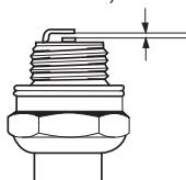
**BEMÆRK!** Brug altid anbefalet tændrørstype! Forkert tændrør kan ødelægge stempel/cylinder. Kontrollér, at tændrøret har såkaldt radiostøjdæmpning.
