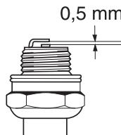
**OBS!** Bruk alltid anbefalt type tennplugg! Feil tennplugg kan ødelegge stempel/sylinder. Påse at tennpluggen har såkalt radiostøyfilter.
