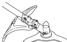
Kontrollér, at beskyttelsen er intakt og fri for revner. Udsift beskyttelsen, hvis den har været utsat for slag eller har revner.
