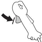
Tryck in gasreglagespärren och kontrollera att den återgår till sitt ursprungsläge när den släpps.
