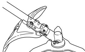
Kontrollera att skyddet är oskadat och fritt från sprickbildning. Byt skydd om det utsatts för slag eller har sprickor.
