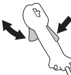
Se anvisningerne under overskriften Start. Start maskinen, og giv fuld gas. Slip gasreguleringen, og kontrollér, at skæreudstyret standser, og at det forbliver i stilstand. Hvis skæreudstyret roterer med gasreguleringen i tomgangsstilling, skal karburatorens
