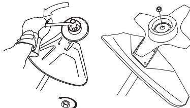
Låsemutterens nylonlåsing må ikke være så slitt at den kan skrus med fingrene. Låsinga må holde minst 1,5 Nm. Mutteren må skiftes etter at den har vært skrudd på ca. 10 ganger.
