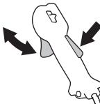
Se anvisninger under overskriften Start. Start maskinen og gi full gass. Slipp gassregulatoren og kontroller at skjæreutstyret stanser og at det blir stående stille. Hvis skjæreutstyret roterer når gassregulatoren står i tomgangsstilling må forgasserens tomgangsjustering
