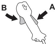
Kontrollér, at gasreguleringen er låst i tomgangsstilling, når gasreguleringslåsen befinner sig i udgangsstilling.
