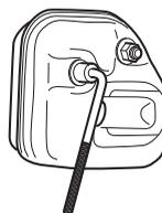
Si le silencieux comporte une grille antifleme, la nettoyer régulièrement. Une grille colmatée résulte en un échauffement du moteur pouvant donner lieu à de graves avaries du moteur.
