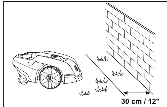
Si la zone de travail est délimitée par un petit fossé, par exemple une plate-bande, une petite surélévation ou un petit bord de trottoir (0.4-2"/1 à 5 cm), le câble périphérique doit être placé à 8"/20 cm à l'intérieur de la zone de travail. De cette manière, les roues ne risquent pas de basculer dans le fossé ou de monter sur le rebord.
