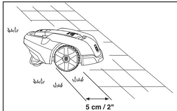
Si la zone de travail est divisée par une allée pavée au même niveau que la pelouse, le robot de tonte peut rouler sur l'allée. Il peut être avantageux de disposer le câble périphérique sous les pavés. Le câble périphérique peut aussi être placé dans le joint entre les pavés. Assurez-vous que le carrelage est au même niveau que la pelouse afin d'éviter une usure excessive du robot de tonte.
