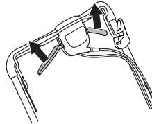
Když se pohon začne zpomalovat, seřídíte lanko ovládání spojky. Jemně seřídíte lanko pomocí seřizovacího šroubu.
