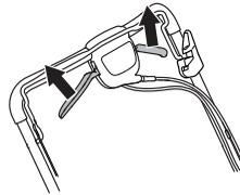
Når drevet følelse langsomt du nødt til at justere koblingskablet. Finjuster kablet vha. justeringsskruen.
