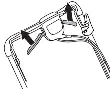
Als de aandrijving langzaam aanvoelt, dient u de koppeldraad aan te passen. Stel de draad nauwkeurig af met de afstelschroef.
