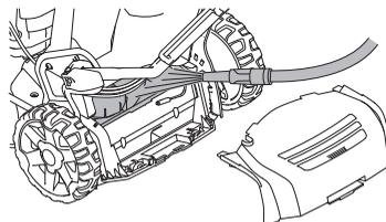
Виметіть листя і траву з корпусу редуктора. Якщо необхідно, вимийте корпус редуктора водою.
