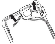
Kun veto alkaa tuntua hitaalta, kytkinvajeria on säädettävä. Säädä hieman johtoa säätöruuvien avulla.
