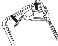
Jeśli napęd słabnie, wyreguluj linkę sprzęgła. Długość linki sprzęgła można precyzyjnie wyregulować przy użyciu śruby regulacyjnej.
