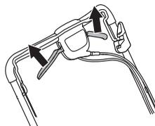
Quando l'unità comincia a essere lenta, è necessario regolare il filo della frizione. Effettuare la regolazione precisa del cavo utilizzando la vite di regolazione.
