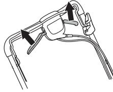
Σε περίπτωση επιβράδυνσης του συστήματος μετάδοσης κίνησης, προσαρμόστε τη ντίζα του συμπλέκτη. Τέλος, ρυθμίστε το καλώδιο με τη βίδα ρύθμισης.
