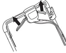
Когда скорость привода начнет снижаться, следует отрегулировать трос сцепления. Точно отрегулируйте длину троса с помощью регулировочного винта.
