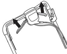
Haben Sie das Gefühl, dass der Antrieb langsam voran geht, muss das Kupplungsseil angepasst werden. Nehmen Sie die Feineinstellung des Drahts mithilfe einer Stellschraube vor.
