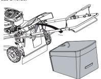
3 Relâchez la protection arrière et laissez-la reposer sur le dessus du châssis du sac à herbe.
