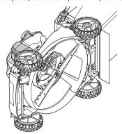
4 Placer une cale en bois entre la lame et le carter pour éviter que la lame ne tourne lors du démontage du boulon de lame.
