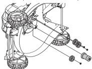
Retirer la courroie de l'adaptateur de lame/la poulie du moteur et du bloc de poulie tendeur.
