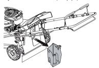
2 Fermez la protection arrière pour permettre à la machine de décharger le matériau sur le côté gauche de la machine lors de la coupe.
