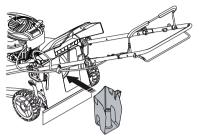
3 Laissez la protection arrière se refermer et veillez à ce qu'elle repose fermement contre l'obturateur du broyeur.
