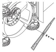
4 Placer une cale en bois entre la lame et le carter de la tondeuse et serrer le boulon de lame, en le tournant dans le sens des aiguilles d'une montre.
