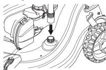
5 Ouvrir l'alimentation d'eau et vérifier qu'il n'y a pas de fuite au niveau du raccord. 6 S'il n'y a pas de fuite, démarrer le moteur et le laisser tourner jusqu'à ce que le dessous de la tondeuse soit propre.
