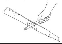
IMPORTANT! Après tout aiguisage, il faudra vérifier l'équilibrage des couteaux. Il n'est pas recommandé d'affûter les lames. L'affûtage ou l'équilibrage des lames doit être effectué dans un atelier d'entretien agréé.
