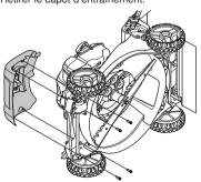
Retirer le boulon de lame en le tournant dans le sens inverse des aiguilles d'une montre. Retirer la lame et le matériel de fixation : boulon, rondelle frein et rondelle durcie
