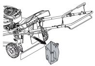
2 Soulevez la protection arrière et placez les crochets du châssis du collecteur d'herbe sur les supports du sac à herbe.
