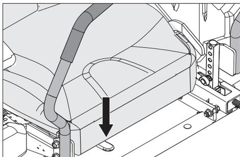
Le siège peut être réglé dans le sens de la longueur. Le levier se trouve sous le côté droit du siège (du point de vue du conducteur). Au moment de procéder aux réglages, le levier est tiré vers la gauche.
