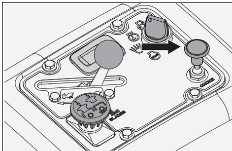
La commande d'étrangleur est utilisée lors des démarrages à froid afin d'enrichir le mélange gazeux.
