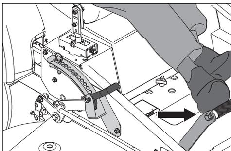
La goupille de hauteur permet de régler la hauteur de coupe souhaitée. La pédale de hauteur de coupe relâche le levage de l'unité et place l'unité à la hauteur sélectionnée.
