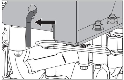
Les leviers sont situés sur chaque côté à l'arrière de l'unité, en-dessous de la plaque arrière du moteur. La tringlerie de dérivation sert à pousser ou tirer à la main l'unité.
