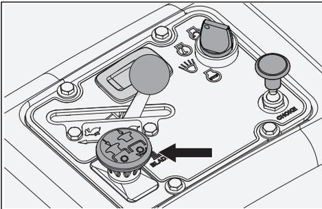
Pour engager la tête de coupe, tirer sur la molette de l'interrupteur de lame. Les lames de la tondeuse sont débrayées lorsque le bouton est enfoncé.
