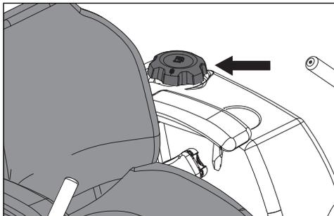
Lire les consignes de sécurité avant d'effectuer un plein de carburant. La machine comporte un réservoir de carburant se trouvant derrière la console. Le volume du réservoir est de 13,25 litres (3,5 gallons).
