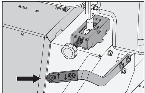
Le frein de stationnement se trouve du côté gauche de la machine. Tirez le levier vers l'arrière pour activer le frein et poussez-le vers l'avant pour le relâcher.
