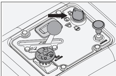
L'interrupteur d'allumage se trouve dans le panneau de commande et il sert pour le démarrage et l'arrêt du moteur.
