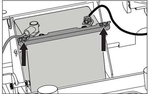
5. Utiliser deux clés 1/2 po pour débrancher le câble de batterie NOIR, puis le câble de batterie ROUGE.
