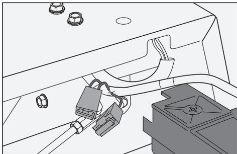
Les fusibles se trouvent du côté gauche de la machine. Ils sont accessibles en faisant basculer le siège vers l'avant. Il s'agit de fusibles plats semblables à ceux utilisés dans les véhicules automobiles. Le 20 A est le fusible principal. Les 7,5 A est pour le couplage plateau tondeuse.
