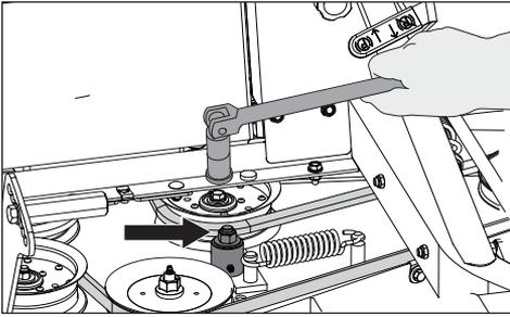
4. Acheminer avec soin la courroie sur le dessus des poulies du logement des lames et retirer la courroie.
